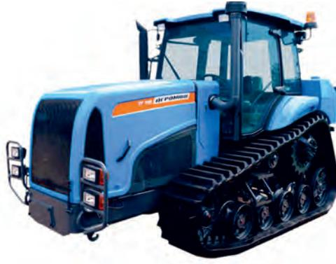
Гусеничный, тягового класса 3. Гусеничный обвод ходовой части выполнен в форме треугольника, в верхней части которого находятся ведущие колеса. Гусеницы резиноармированные. Подвеска опорных катков независимая, торсионная.
