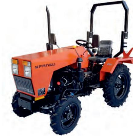
Полноприводный, с отключаемым передним мостом и принудительной блокировкой дифференциала.
