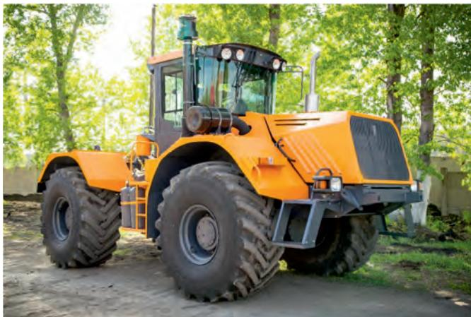
Шарнирно-сочлененный, тягового класса 7, оснащается одним из трех двигателей: ЯМЗ-238М2; ЯМЗ-238Д; ЯМЗ-7511. Коробка передач механическая, четырехрежимная (три режима вперед, один – назад), с шестернями постоянного зацепления и гидравлическим переключением передач без разрыва потока мощности в пределах каждого режима. Мосты с автоматической блокировкой межколесного дифференциала (No-Spin).
