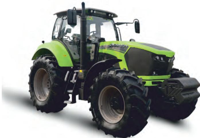
Тяговых классов 4-5, оснащен 6-цилиндровым двигателем с турбонаддувом и промежуточным охлаждением, системой впрыска топлива Common Rail с электронным управлением. В трансмиссии использована автоматизированная коробка передач компании ZF Friedrichshafen AG (Германия). Управляется электронным блоком, выбор нужной передачи зависит от нагрузки и текущих условий эксплуатации.
