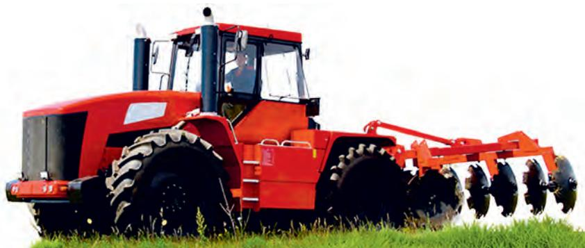
Тягового класса 5, предназначен для выполнения работ по основной и предпосевной обработке почвы, боронованию, с широкозахватными посевными комплексами и транспортными работ.
