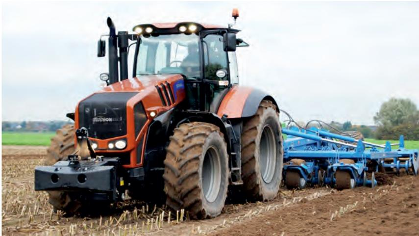
Тяговых классов 6-8, предназначен для работы в составе высокопроизводительных широкозахватных и комбинированных агрегатов.
