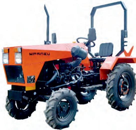
Предназначен для выполнения работ по обработке почвы, уборке, хранению и последующей переработке агрокультур, а также для коммунальных и строительных работ. Оснащен 3-цилиндровым двигателем КМ-385ВТ.
