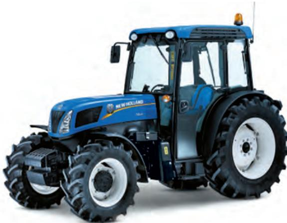
Оснащены 4-цилиндровыми двигателями с промежуточным охлаждением всасываемого воздуха. Соответствуют нормам токсичности отработавших газов Tier III. Способны без модификации работать на биодизельном топливе.
