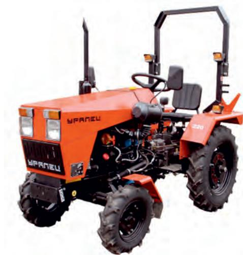
Оснащен 2-цилиндровым двигателем JD295 с пуском от электростартера. Муфта сцепления сухая, однодисковая, постоянно замкнутая. Остов безрамный, передняя ось трубчатая, с балансирной подвеской. Рулевое управление механическое или гидрообъемное, тормоза механические, на задние колеса, ВОМ зависимый.
