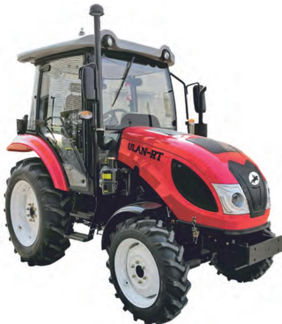
Универсальный, может также использоваться в строительной, строительско-дорожной и коммунальной отраслях. Для этого дополнительно комплектуется фронтальным погрузчиком, коммунальным или бульдозерным отвалом, щеткой, разбрасывателем песка, бурильной установкой, прицепом и др.
