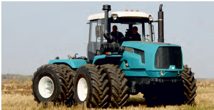
Колесные, с шарнирно-сочлененной рамой. Предназначены для выполнения энергоемких сельскохозяйственных работ: обработки почвы, посева, уборки, кормозаготовки, транспортировки грузов. Особенно эффективны в сельхозпредприятиях с площадью угодий до 3000 га.
