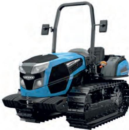
Гусеничные, оснащены 4-цилиндровыми двигателями с четырьмя клапанами на цилиндр, катализатором окисления дизельного топлива (DOC), сажевым фильтром (DPF) с пассивной регенерацией и каталитическим нейтрализатором SCR. Соответствуют нормам токсичности отработавших газов Stage V.
