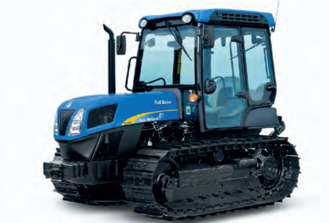
Гусеничный, предназначен для работы в садах и виноградниках. Оснащен 4-цилиндровым двигателем с турбонаддувом, промежуточным охлаждением воздуха и системой впрыска топлива Common Rail. Соответствует экологическим нормам Tier III.
