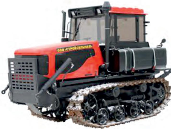
Гусеничный, общего назначения, тягового класса 3, предназначен для выполнения основных сельскохозяйственных работ в агрегате с навесными, полунавесными и прицепными гидрофицированными машинами и орудиями с пассивными и активными рабочими органами. С соответствующим оборудованием может использоваться на дорожно-строительных, мелиоративных, погрузочно-разгрузочных и транспортных работах. Торфяная модификация позволяет проводить сложные работы в условиях болотистой местности.
