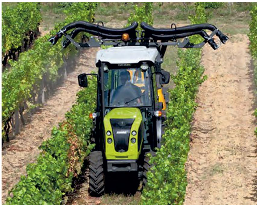
Оснащены 4-цилиндровыми двигателями с турбонаддувом, охлаждением наддувочного воздуха и рециркуляцией отработавших газов. Соответствуют нормам токсичности отработавших газов Stage IIIA (Tier 3).
