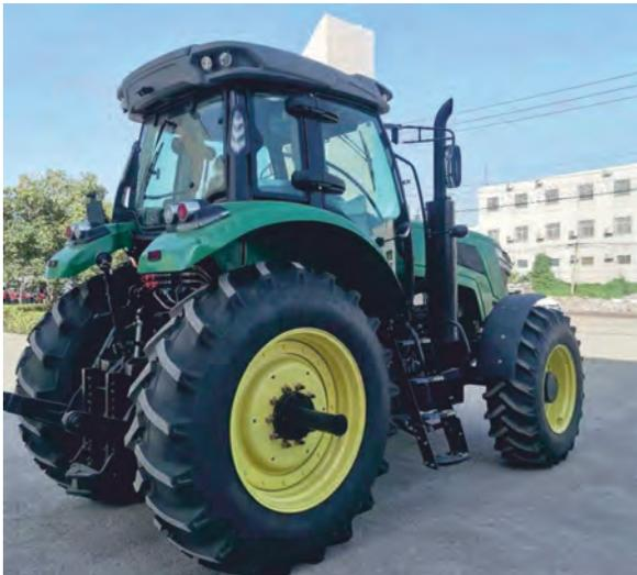
Универсальный, может также использоваться в строительной, строительной-дорожной и коммунальной отраслях. Для этого дополнительно комплектуется различным оборудованием: фронтальным погрузчиком, коммунальным или бульдозерным отвалом, щеткой, разбрасывателем песка, бурильной установкой, прицепом и др. Модульного типа, полноприводный, с отключаемым передним мостом и гидроусилителем руля.
