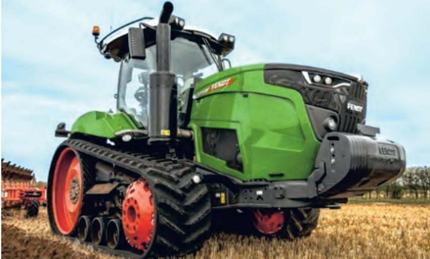
Гусеничные, оснащены 7-цилиндровыми двигателями с двумя последовательно установленными турбокомпрессорами.
