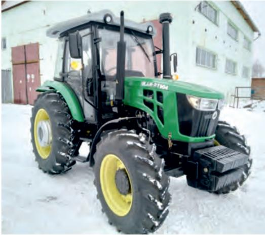
Универсальный, может также использоваться в строительной, строительно-дорожной и коммунальной отраслях. Для этого дополнительно комплектуется различным оборудованием: фронтальным погрузчиком, коммунальным или бульдозерным отвалом, щеткой, разбрасывателем песка, бурильной установкой, прицепом и др.
