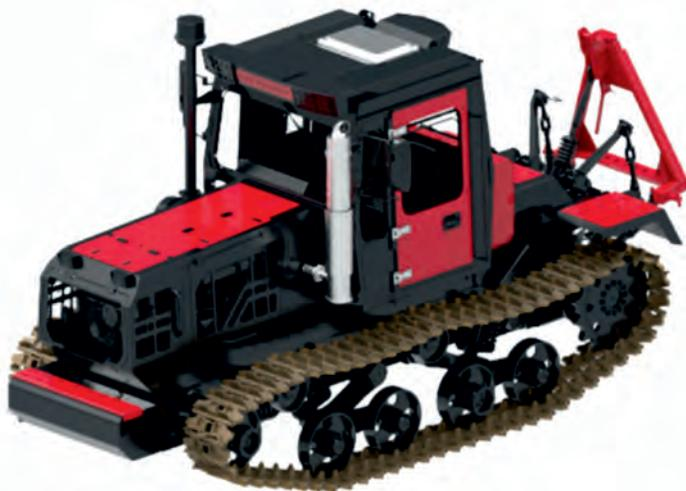
Гусеничный, тягового класса 6, предназначен для работы в сельском и лесном хозяйстве в агрегате с навесными, полунавесными и прицепными гидрофицированными машинами и орудиями.
