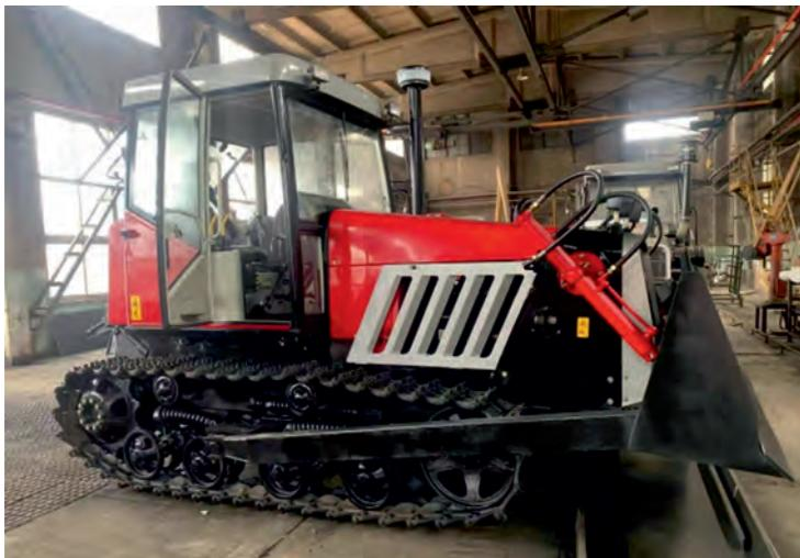
Гусеничный, предназначен для выполнения работ в сельскохозяйственной и строительной отраслях, горнодобывающей сфере и лесном хозяйстве, где необходимо обеспечить наименьшее давление на грунт при большой площади соприкосновения с поверхностью. Одно из назначений – работа с бульдозерным оборудованием за счет высоких тяговых показателей.
