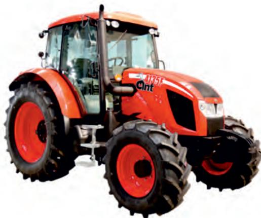
Многофункциональный, тягового класса 2, предназначен для выполнения сельскохозяйственных работ в агрегате с навесными, полунавесными и прицепными агрегатами и орудиями, может использоваться как для специальных, так и для транспортных работ.
