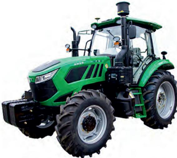
Полноприводные, оснащены 4-цилиндровыми двигателями с турбонаддувом и охлаждением наддувочного воздуха. По уровню токсичности выхлопных газов отвечают нормативам Stage III. Муфта сцепления сухая, однодисковая, двойного действия. Коробка передач механическая, реверсивная. Кабина шумоизолированная, герметичная, с люком, фильтрами салона, и панорамным остеклением.
