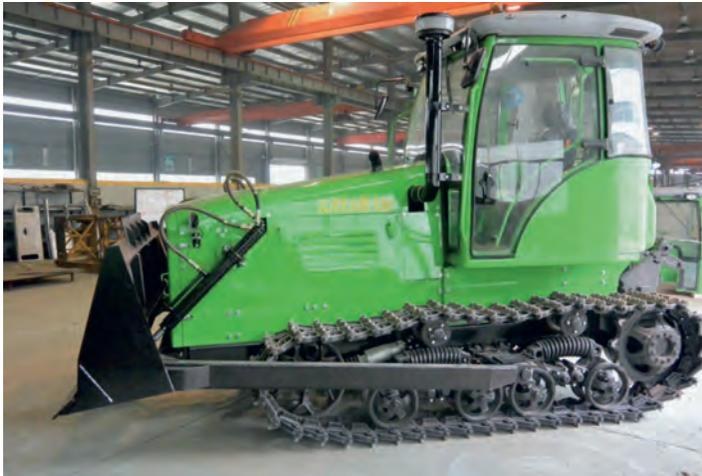
Гусеничный, общего назначения, тягового класса 4, предназначен для вспашки сложных и целинных земель и использования в качестве базового шасси для оснащения навесными и прицепными агрегатами и механизмами. Может применяться с бульдозерным отвалом.
