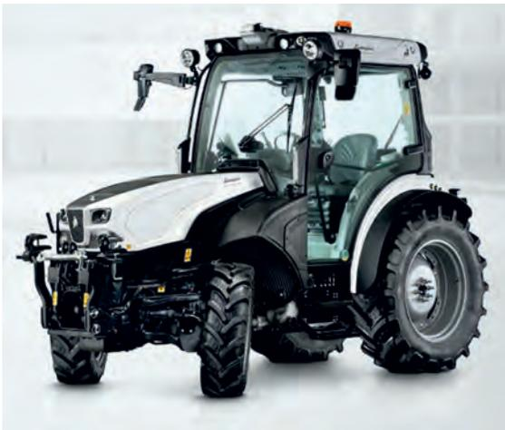
Оснащены двигателями с турбонаддувом, охлаждением наддувочного воздуха, системой подачи топлива Common Rail с электронным управлением и системами доочистки выхлопных газов (DPF, SCR, DOC и EGR). Соответствуют нормам токсичности отработавших газов Stage V.
