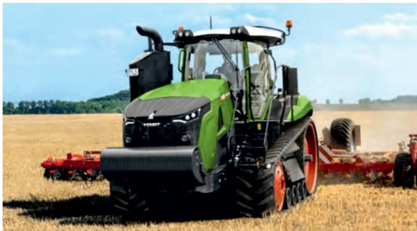
Гусеничные, оснащены 6-цилиндровыми двигателями с турбокомпрессором с изменяемой геометрией и системой Common Rail с давлением впрыска до 2500 бар. Соответствуют требованиям стандарта токсичности выхлопных газов Stage V. Доочистка отработавших газов обеспечивается катализатором окисления (DOC), сажевым фильтром (DPF) и системой SCR (селективная каталитическая нейтрализация).
