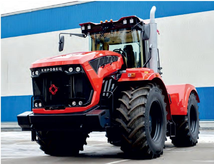
Сельскохозяйственный, колесный, общего назначения, тягового класса 5, с шарнирно-сочлененной рамой. Предназначен для выполнения пахоты, культивации, боронования, внесения удобрений, посева, силосования, снегозадержания и транспортных работ в хозяйствах с посевной площадью 1500 га и более.
