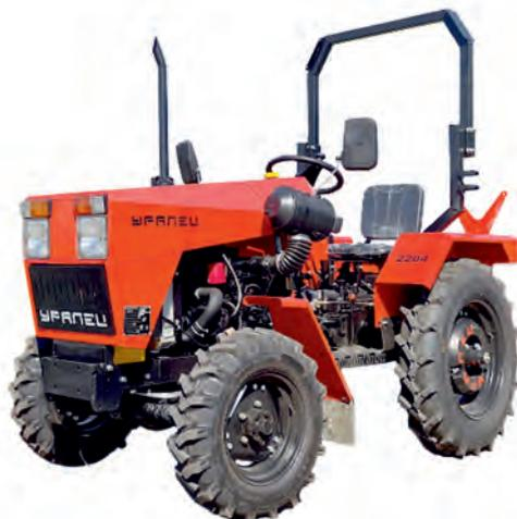
Полноприводный, с отключаемым передним мостом и принудительной блокировкой дифференциала. Предназначен для выполнения работ по обработке почвы, уборке, хранению и последующей переработке агрокультур, а также для коммунальных и строительных работ.
