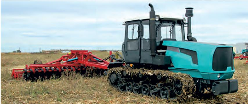
Гусеничный, предназначен для выполнения энергоемких сельскохозяйственных работ по обработке средних и тяжелых почв, закрытию влаги, дискованию, севу, орошению, уборке, кормозаготовке.
