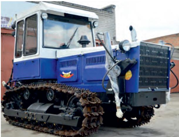
Гусеничный, общего назначения, тягового класса 4, предназначен для сельскохозяйственных, промышленных, транспортных и подсобных работ как тягово-энергетическая база для навесного рабочего оборудования. Благодаря жесткой реечной 12-катковой подвеске эффективен как база для бульдозерного оборудования.
