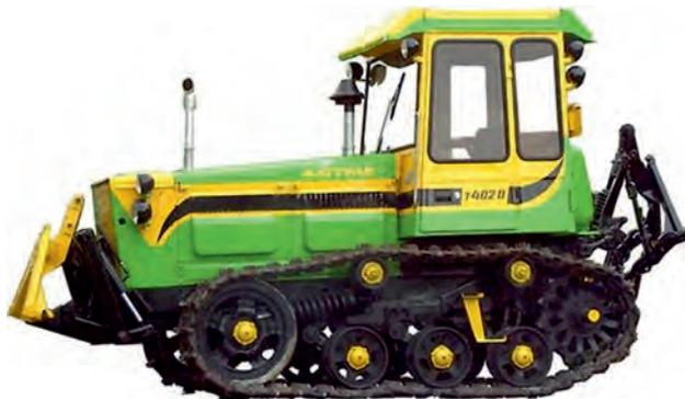
Гусеничный, общего назначения, тягового класса 4, предназначен для выполнения энергоемких работ в сельском хозяйстве (пахота, культивация, транспортировка грузов), а также землеустроительных и мелиоративных работ.
