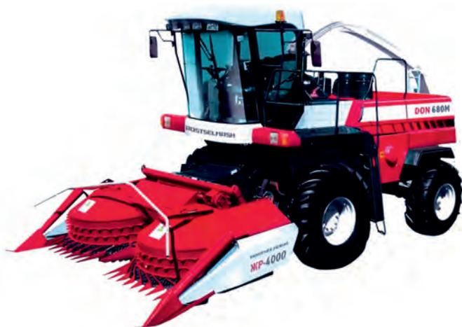
Оснащен 8-цилиндровым двигателем с турбонаддувом. Компактное V-образное расположение цилиндров двигателя позволяет разместить его поперечно. При такой компоновке возможна наиболее эффективная передача крутящего момента рабочим органам комбайна.
