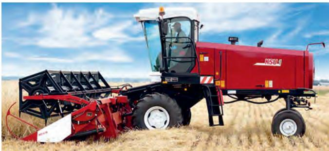
Оснащается двигателями ЯМЗ. Включает в себя самоходное шасси для уборочных машин (энергосредство) ШС-150 и следующие адаптеры: косилка (жатка) валковая транспортерная DRAPER FLOW 700/900 с шириной захвата 7,0/9,0 м; косилка-плющилка GRASS MOWER 500 с шириной захвата 5,0 м; косилка-измельчитель навесная JET STREAM 270 с шириной захвата 2,7 м; косилка роторная фронтальная GRASS MOWER 350 с шириной захвата 3,5 м.
