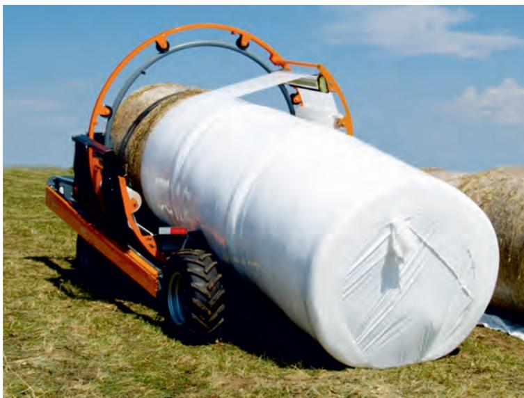
Привод на два колеса позволяет упаковщику передвигаться по полю на короткие расстояния, а в режиме упаковки – осуществлять подтормаживание для эффективного вытеснения воздуха между рулонами. Цикл упаковки рулона выполняется автоматически.
