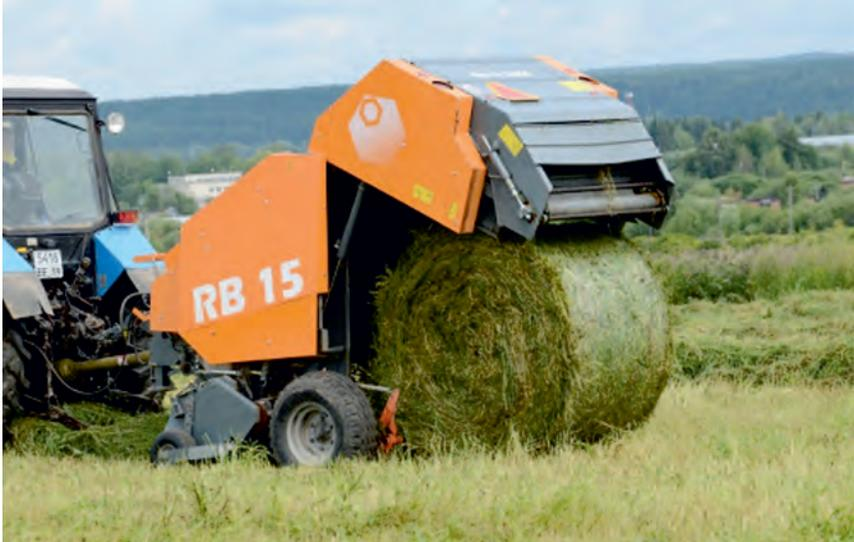
Оснащены постоянной камерой прессования  $\varnothing$  1,5 м с бесконечным прессующим транспортером; укладчиком, который создает безостановочный поток прессуемой массы в камеру прессования, что способствует получению рулонов правильной цилиндрической формы. Натяжение транспортера производится пружинным блоком и не требует частых регулировок, что исключает её ослабление во время открытия камеры и разрыв при резком включении транспортера.
