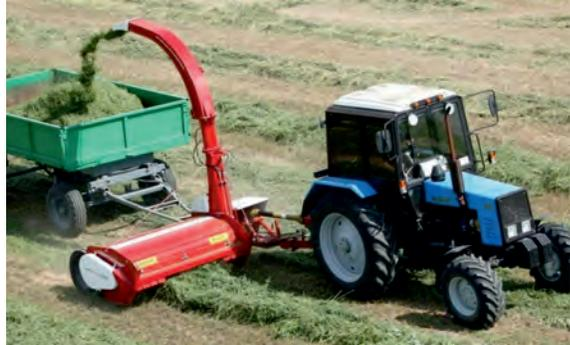
початков и других силосуемых культур высотой стебля не более 1,5 м с одновременной погрузкой измельчённой массы в транспортное средство; для скашивания, измельчения и погрузки в транспортное средство ботвы сахарной свеклы и картофеля с междурядьями 45 и 70 см; для скашивания, измельчения и разброса по полю измельчённой стерни подсолнечника, остающейся на поле после уборки семян. Может использоваться во всех почвенно-климатических зонах, кроме горных районов.
