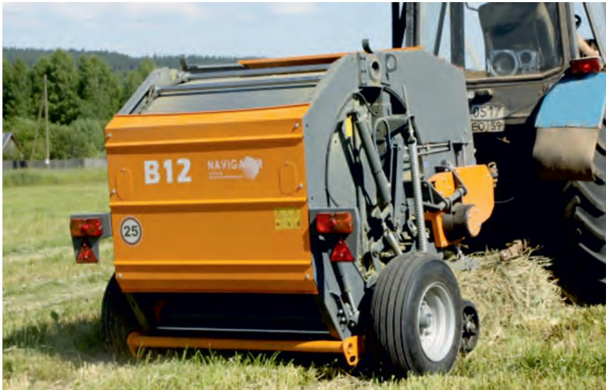
Высокая плотность прессования достигается благодаря камере постоянного размера в сочетании с планчатым транспортером. Натяжение транспортера производится пружинным блоком и не требует частых регулировок, что исключает разрыв при резком включении транспортера.
