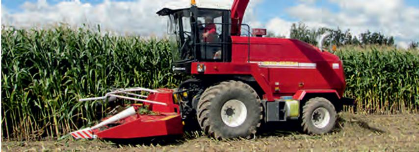
В качестве опции оснащается жатками для уборки трав, что позволяет за одну операцию скашивать и измельчать травостой, обеспечивая получение зеленых кормов. Поддерживать высокий темп работы позволяет ускоритель выброса. Мощный поток измельчённой массы плотно заполняет кузова транспортных средств, обеспечивая максимальное использование их объёма и сокращая количество рейсов на отгрузке кормов.
