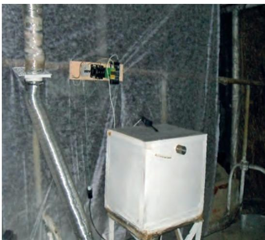
*Лабораторная установка по моделированию процесса биологической фильтрации газов*
