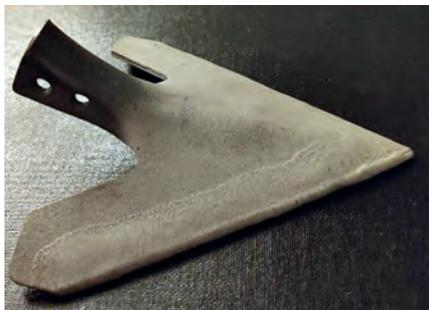
*Стрельчатая лапа, восстановленная ППН твердосплавных электроэрозионных материалов*
