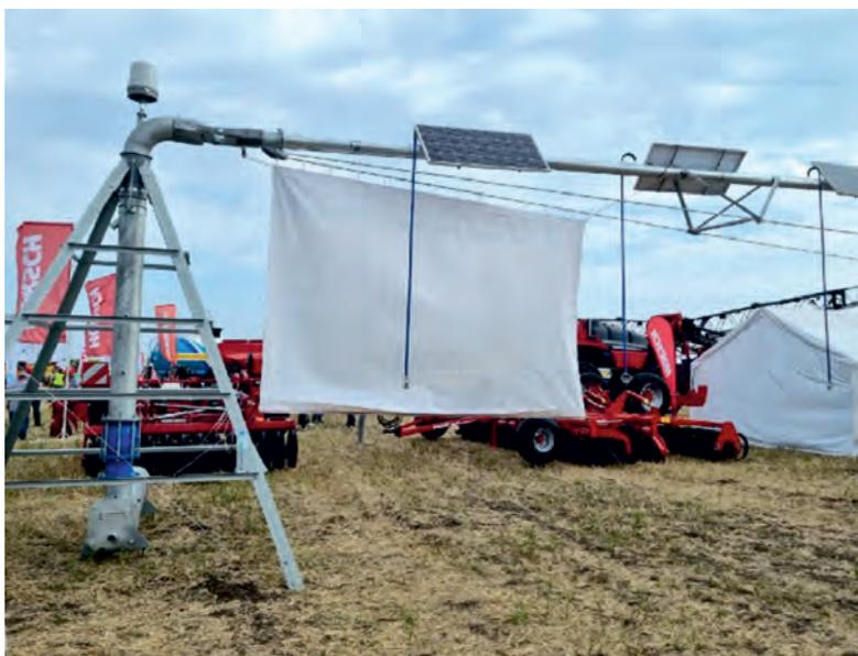
Представленная разработка автономного роботизированного комплекса с использованием солнечных модулей позволит исключить затраты фермеров на топливно-энергетические ресурсы и строительство протяженных кабельных линий, обеспечит полностью автоматическую эксплуатацию дождевальных машин.
