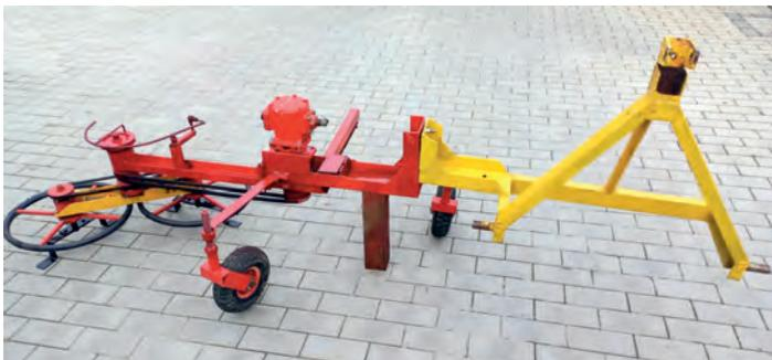
*Опытный образец двухроторной фрезы
