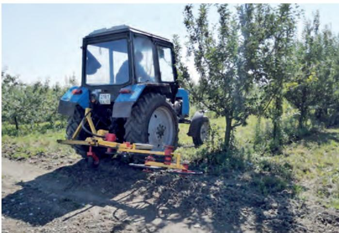
*Производственные испытания двухроторной фрезы*
