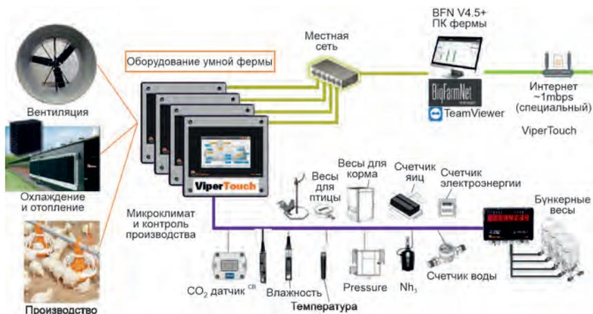
Рис. 3.2. Схема коммутации контроллера в птичнике
