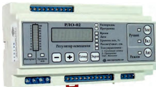
Рис. 3.27. Регулятор освещения РЛО-02 компании «Резерв» (г. Тула)
