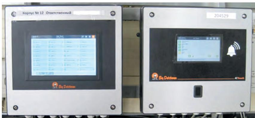
*Рис. 3.22. Компьютер ViperTouch с прибором AC Touch*
