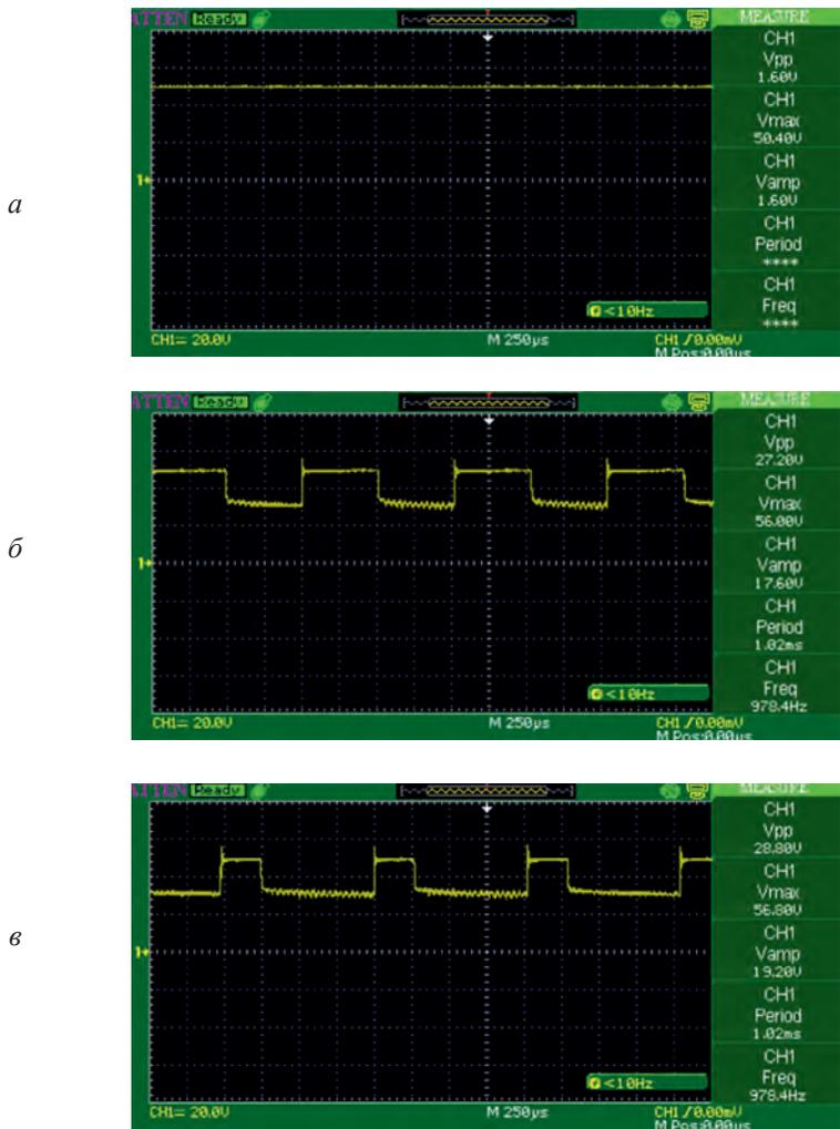
*Рис. 3.29. Осциллограмма напряжения питания, поступающего на светодиодные светильники компании «Техносвет Групп»:*
