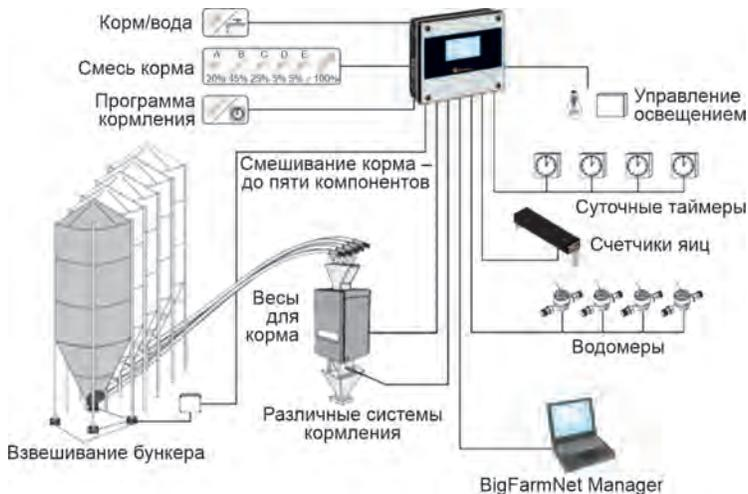
Рис. 3.42. Принципиальная схема управления системой кормораздачи в птичнике
