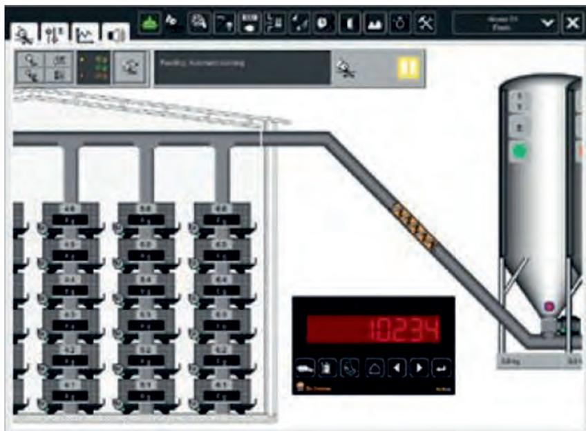
Рис. 3.8. Учет расхода корма с помощью бункерных весов
