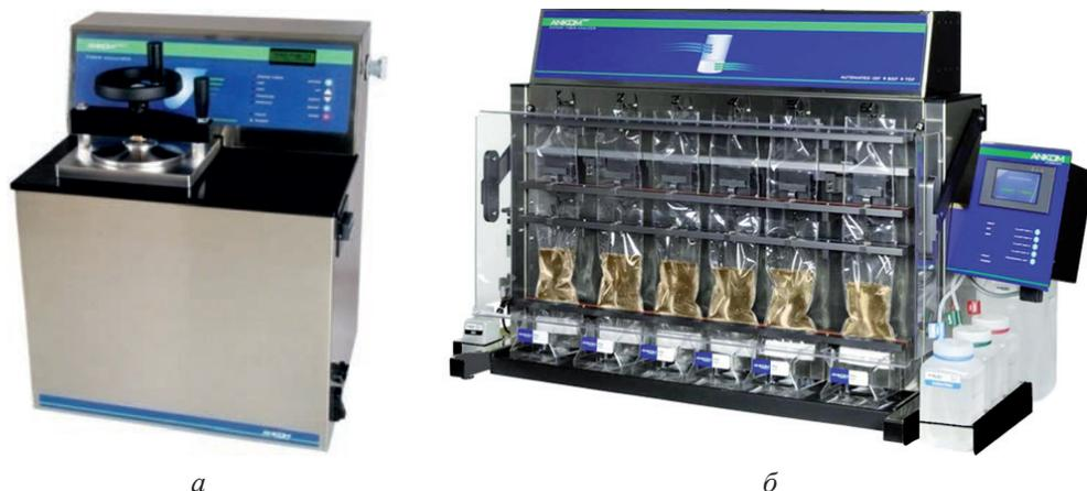
Рис. 2. Анализаторы клетчатки ANKOM<sup>2000</sup> и ANKOM<sup>TDF</sup> (б) компании «ANKOM Technology» (США)
