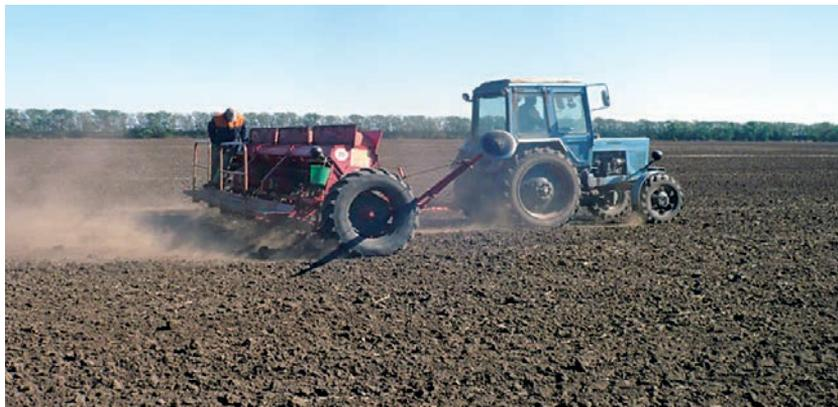
Рис. 1. Общий вид сеялки зернутоковой СЗ-5,4 в агрегате с трактором МТЗ-82
