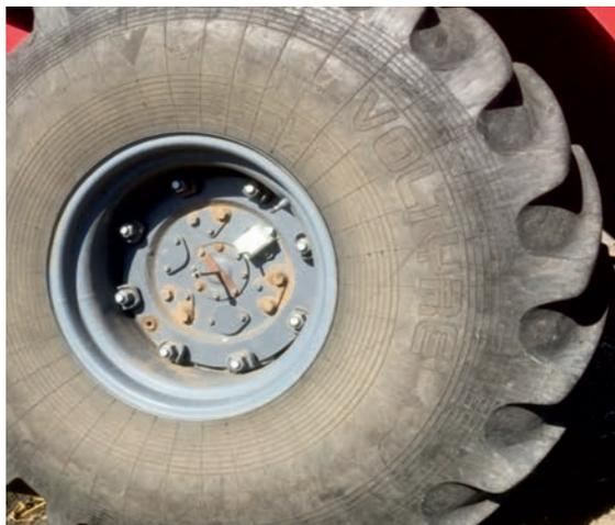
*Рис. 3. Инерциальный датчик угла поворота ИП-291 на колесе трактора К-744Р2*
