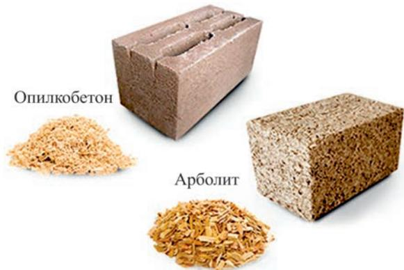
Рис. 1. Внешний вид опилкобетона и арболита
