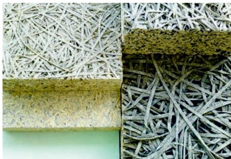
Рис. 2. Внешний вид фибролита
