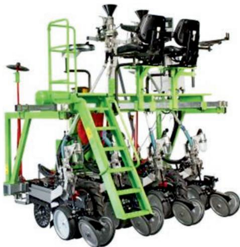
*Рис. 3. Навесная сеялка пунктирного посева Monoseed В/К/DT*
