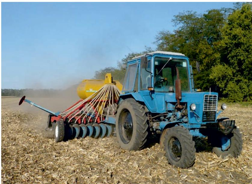
*Рис. 3. Общий вид посевного комплекса Р-4,2 в агрегате с трактором МТЗ-82 на посеве озимой пшеницы*
