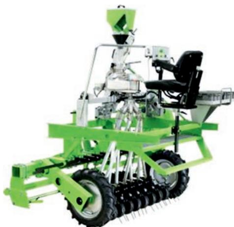
Рис. 2. Навесная порционная селекционная сеялка Plotseed XL
