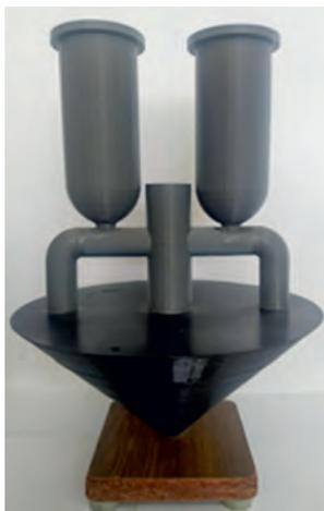
**Назначение.** Усовершенствованное устройство относится к сварочному производству, в частности к устройствам для смешивания порошков при наплавке. Может использоваться при восстановлении и упрочнении деталей порошковыми смесями.
