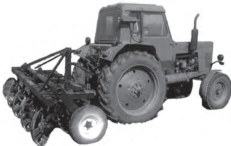
**Аннотация.** Разработка и внедрение в производство комбинированного культиватора с принципиально новыми коническими рабочими органами (адаптерами) для поверхностной мульчирующей обработки почвы при возделывании сельскохозяйственных культур по интенсивным технологиям обеспечивает снижение энергоемкости и повышение качества выполнения технологического процесса.
