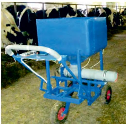
**Назначение.** Раздача комбикормов дойным животным с учетом их продуктивности и физиологического состояния с высокой точностью дозирования.
