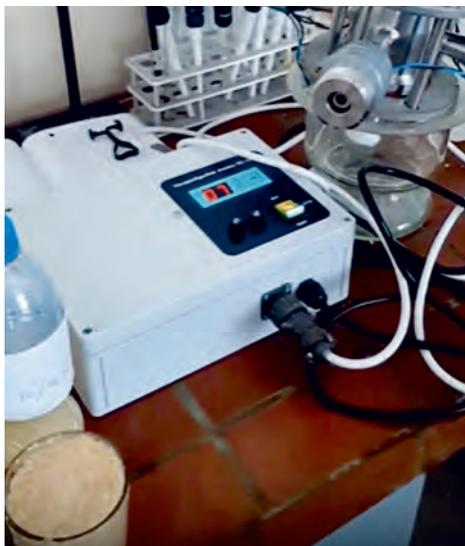
*Кавитационная ячейка производства ООО «Новотех-ЭКО» (г. Вологда) и опытные лабораторные образцы кормовой добавки*
