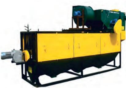
Предназначена для предварительной очистки вороха зерновых, колосовых, зернобобовых, крупяных культур и кукурузы, поступающего от комбайнов или других молотильных устройств, от легких, крупных и мелких сорных примесей, отделимых воздушным потоком
