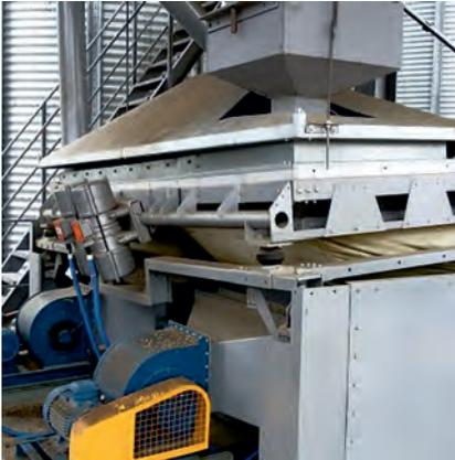
Предназначен для очистки зерна от трудновыделимых примесей и разделения семенного материала по плотности, размеру, форме и свойствам поверхности.
