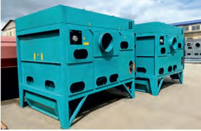
Предназначена для обработки крупяных, зерновых и зернобобовых культур от легких, мелких, крупных зерновых и минеральных примесей и щуплого зерна. Позволяет калибровать продукт по ширине.
