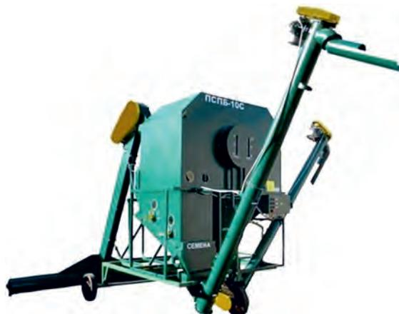
Предназначен для окончательной очистки семян зерновых, колосовых, зернобобовых, крупяных культур, подсолнечника, кукурузы, рапса и сорго.
