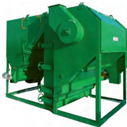
Предназначена для предварительной очистки зерновых, зернобобовых и других культур. В основе работы зерноочистительной машины реализован принцип отделения из зерна примесей, отличающихся от него шириной, толщиной и аэродинамическими свойствами.
