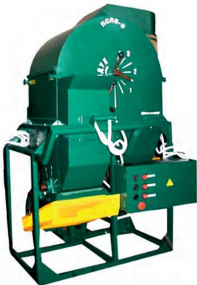
С поворотными барьерами, предназначен для окончательной очистки семян зерновых, колосовых, зернобобовых, крупяных культур, подсолнечника, кукурузы, рапса и сорго в составе технологического оборудования зерноочистительных агрегатов, зерноочистительно-сушильных комплексов и семяочистительных линий. Может индивидуально использоваться в комплекте с устройствами, транспортирующими семенной материал в пневмосепаратор и обеспечивающими прием фракций очистки от пневмосепаратора.
