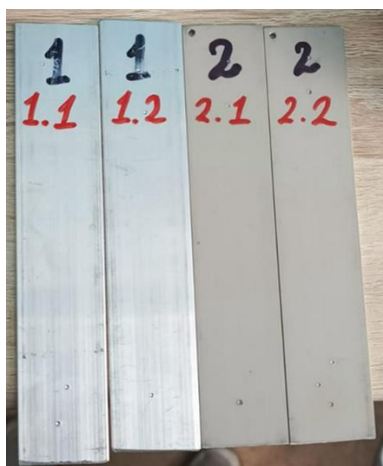
Рис. 1. Образцы для исследований на растяжение и изгиб
