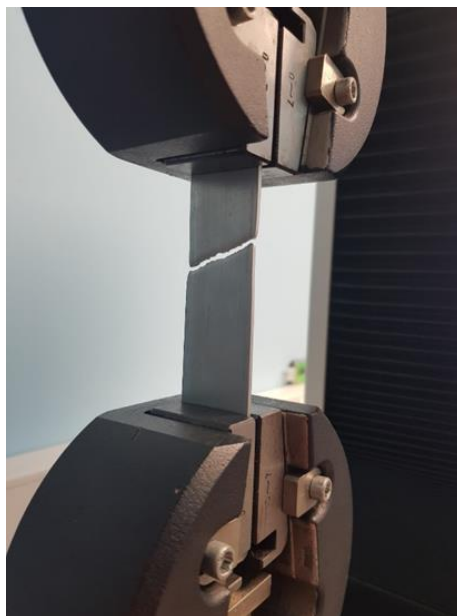
Рис. 3. Установка пластин для исследования на растяжение
