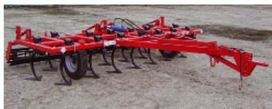
Предназначен для ресурсосберегающей предпосевной и паровой культивации почвы, подрезания и вычесывания сорняков, а также выравнивания и уплотнения поверхности почвы под посев.
