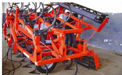
Предназначен для ресурсосберегающей предпосевной и паровой культивации почвы, подрезания и вычесывания сорняков, а также выравнивания и
