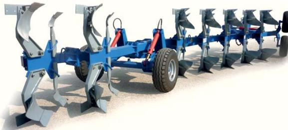
**НАЗНАЧЕНИЕ.** Для пахоты почв под зерновые и технические культуры на глубину до 30 см, не засоренных камнями, плитняком и другими препятствиями, с удельным сопротивлением до 0,09 МПа (0,9 кг/см<sup>2</sup>), углубления пахотного горизонта по отвальным фонам, улучшения лугов и пастбищ, рыхления почв с ровным и волнистым рельефом местности с уклоном до 8°.
