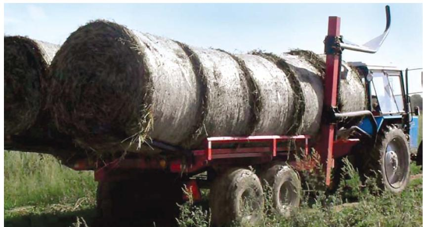
ся по полю с грузом со средней скоростью 20 км/ч, по дороге без груза – 29 км/ч. Коэффициент удельной грузоподъемности при транспортировке рулонов составил 1,8. Разгрузка рулонов проводилась самосвалом на грунтовую площадку. Деформированных и разрушенных рулонов не выявлено. Полнота разгрузки 100%.
