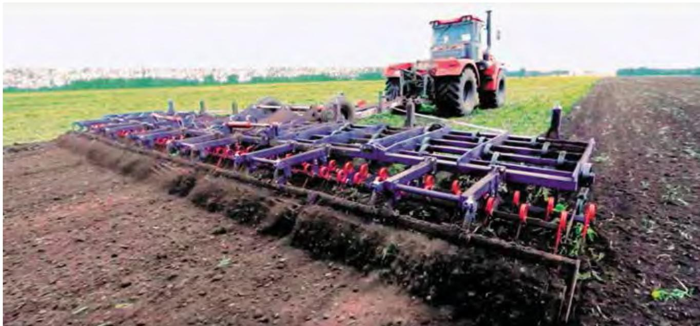
**НОВУЮ МОДЕЛЬ** секционного универсального культиватора КСУ-11 «Алтай» с шириной захвата 11 м разработали специалисты Алтайского НИИ технологии машиностроения. Культиватор успешно прошел заводские испытания в К(Ф)Х Юрия Бакушкина в Ребрихинском районе.
