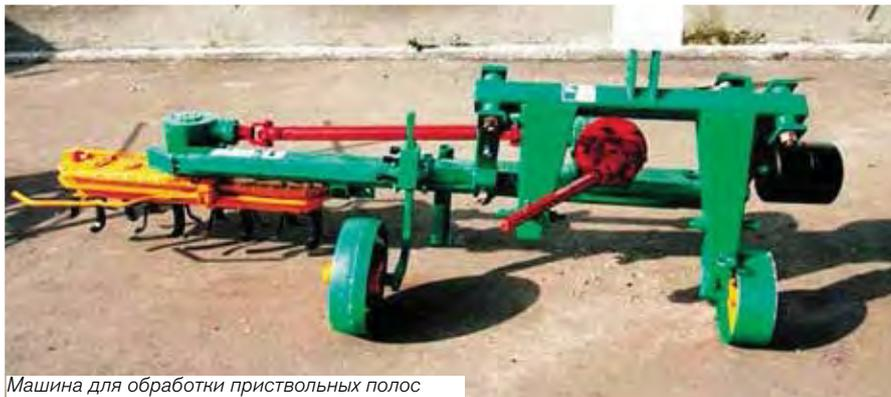
Машина для обработки приствольных полос производства ООО «НПП «ПитомникМаш»
