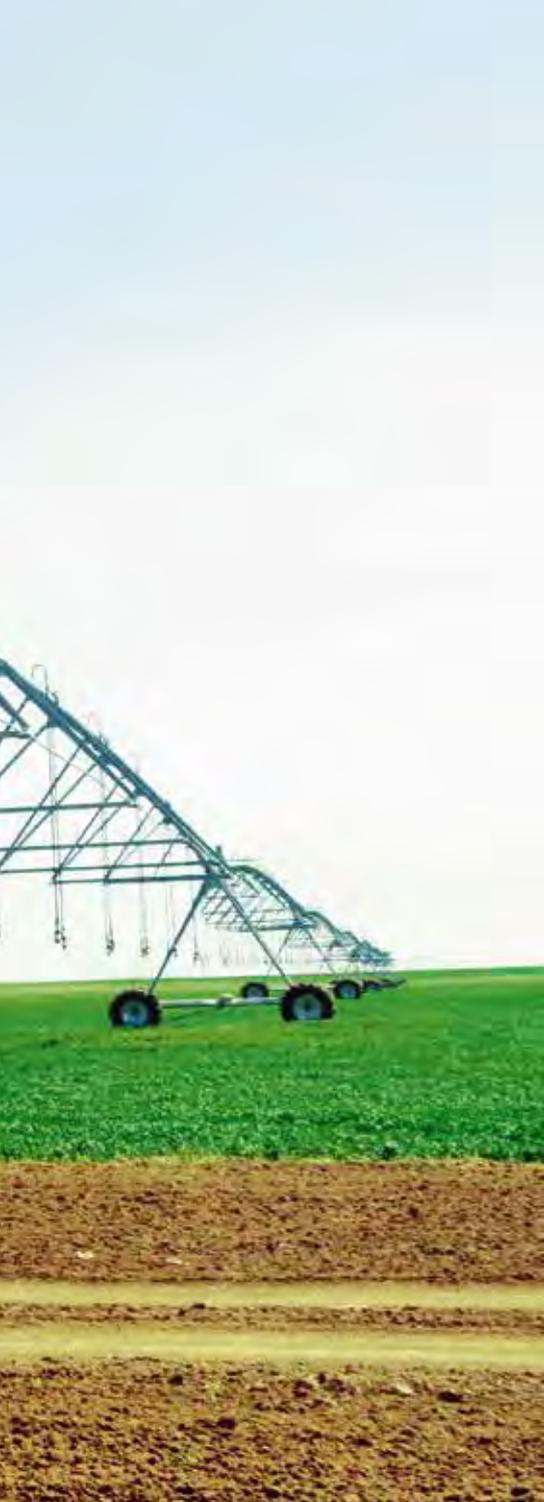
мого участка площадью 304,9 га. Фронтальная дождевальная машина длиной 450 м (поворотная ДМ Western CP 600), новый водовод протяженностью 3,7 км, дизельный генератор и дизельная насосная станция укрепили производственную мощь предприятия. Ввод в 2020 г. 368,2 га орошения (приобретены три фронтальные дождевальные машины и одна машина кругового действия ДМ Western CP 600) позволил создать хорошие условия для выращивания зерновых и зернобобовых культур.
