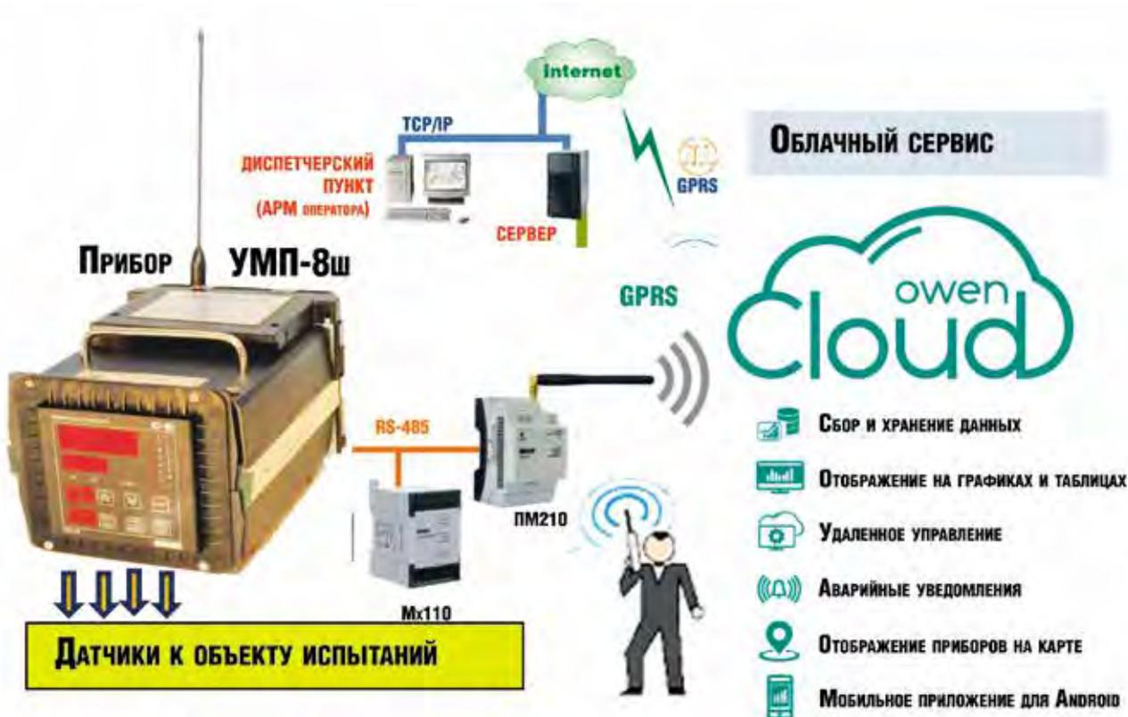
Схема подключения прибора УМП-8ш к объекту испытаний и облачному сервису Owen Cloud
