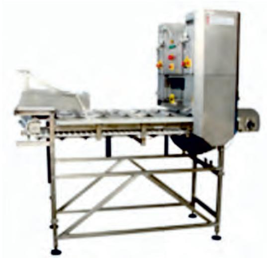
Включает в себя следующие основные части: каркас, приёмный стол, входной лоток, транспортирующее устройство, кожух-лоток, нож, привод ножа, лазер, лоток сброса голов (в комплекте отсутствует), помост, столешницу, лоток сброса рыбы (в комплекте отсутствует), привод головоруба, пистолет.
