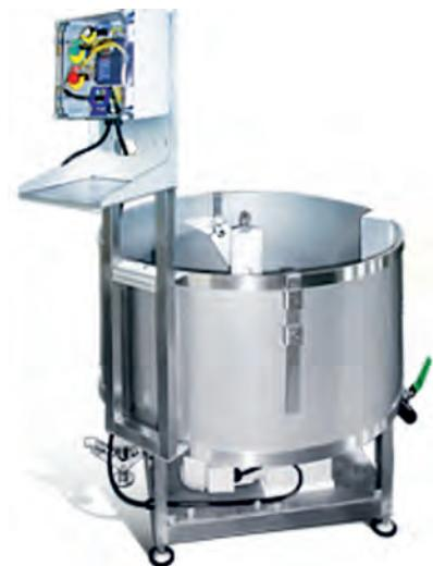
Предназначена для быстрой и равномерной засолки лососевой икры.
