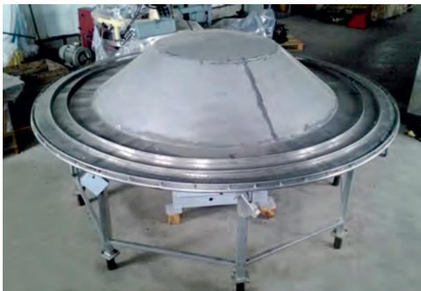
Продукт подается на образующую конуса и вручную укладывается в банку. Подача и отвод банок со стола осуществляются по специальным лоткам, изготовленным в соответствии с транспортными линиями консервного завода.
