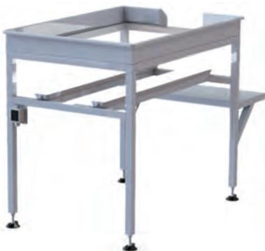
Предназначен для просветки икры после посола перед укладкой в тару. Имеет полупрозрачную поверхность, которая хорошо пропускает свет от ламп, что позволяет эффективно выявлять и отбирать поврежденную (некондиционную) икру.
