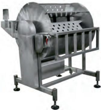
Предназначена для образования контактирующих покрытий (глазури) на поверхности блоков замороженной рыбы. Компактна, может быть интегрирована в любые технологические линии. Глазирование проводится чистой пресной или морской водой температурой 1-3°С путём погружения в неё блоков рыбы.
