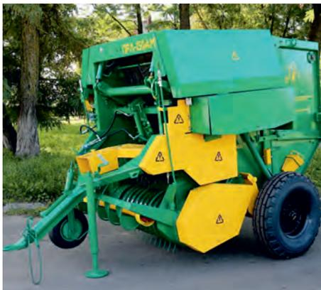
Оборудован камерой прессования переменного объема. Информационно-управляющая система обеспечивает отображение линейной плотности слоя льна в рулоне, окончание формирования рулона и учет количества сформированных рулонов. В конструкцию входит гидромеханическая система для поддержания плотности прессования стеблей с управлением от гидросистемы трактора.
