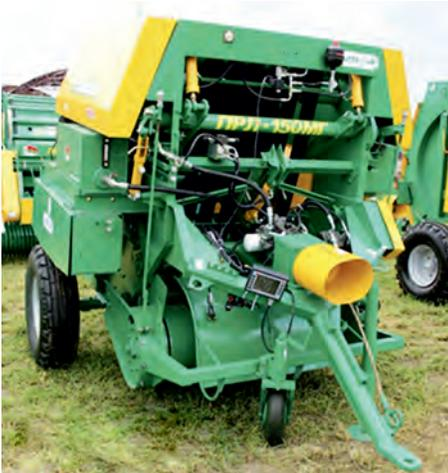
Полуприцепной, предназначен для подбора льнотресты с формированием рулонов и последующей обмоткой их шпагатом. Оборудован камерой прессования переменного объема. В отличие от пресс-подборщика ПРЛ-150АМ оснащен гидроприводом с микропроцессорным регулированием частоты вращения прессующих ремней и подборщика, что обеспечивает форми-
