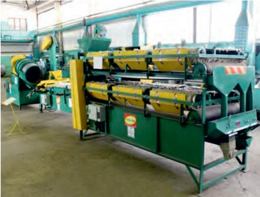
Предназначена для очистки семян льна от сорняков и примесей в закрытых помещениях. Обеспечивает выделение органических и минеральных примесей, щуплых, дробленых и с дефектной поверхностью семян льна.
