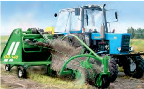
Полуприцепной, предназначен для оборачивания лент льносолломы с целью ускорения и равномерности вылежки стеблей в ходе приготовления сланцевой льнотресты. Применяется для ускорения сушки льносолломы и в процессе вылежки для получения однородной по цвету тресты.
