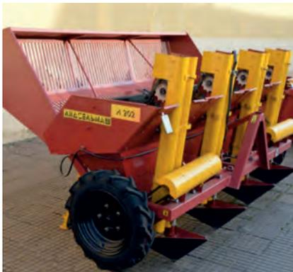
Основные узлы: рама, опорно-приводные колеса, высаживающие аппараты, сошники, бороздозакрыватели, загрузочный бункер, редуктор изменения густоты посадки.
