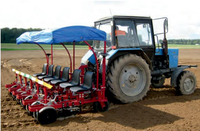
Предназначена для посадки бескассетной рассады капусты в открытый грунт с одновременным поливом или без него с различным расстоянием в ряду.
