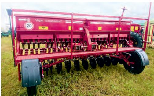
Агрегируется с тракторами тяговых классов: 1,4 – в односеялочном варианте, 2-5 – в многосеялочном (от двух до шести сеялок).
