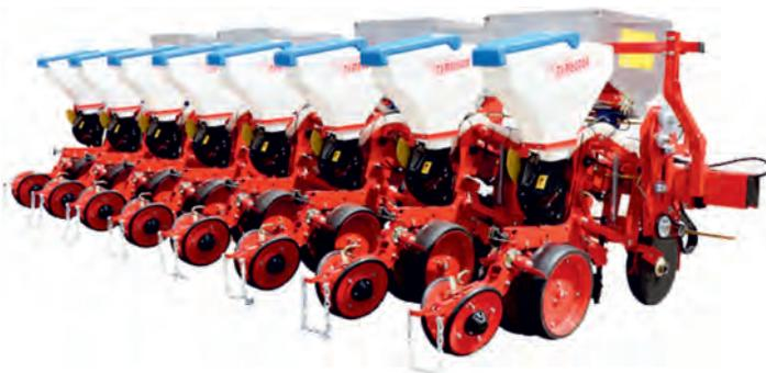
Одновременно с высевом семян вносятся минеральные удобрения. Крыльчатка туковых дозаторов при вращении придает направление и формирует дозу. Частицы через тукопровод равномерной струей попадают в борозду, образованную туковым сошником. При остановке сеялки высев удобрений прекращается.
