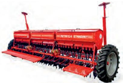
Основные узлы: рама, прицепное устройство, зернотуковый ящик, механизмы передач, сошники, маркёры, опорно-приводные колеса, загортачи, гидросистема.
