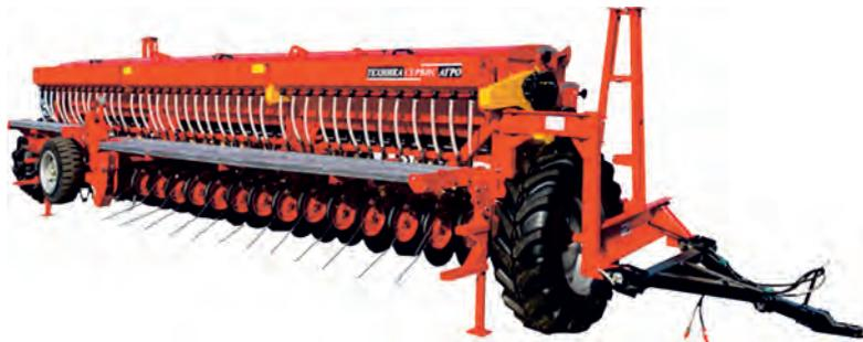
\*Сеялка с транспортным устройством и опорно-прикатными колёсами, бункер заполнен семенами и удобрением (семена пшеницы, плотность удобрений = 1 т/м<sup>3</sup>).
