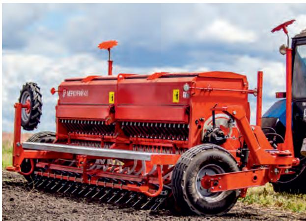
Полуприцепная, предназначена для рядового посева (с одновременным внесением удобрений) семян зерновых (пшеница, рожь, овёс, ячмень), зернобобовых (горох, бобы, соя, люпин), близких по размерам к зерновым культурам (просо, сорго и др.).
