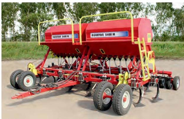
Стрельчатые лапы-сошники обрабатывают почву и формируют семенное ложе. Регулировка глубины проводится изменением высоты передних опорных колес и перестановкой регулировочных клипс на задних подъемных гидроцилиндрах. Семена и удобрения из бункера поступают на катушку дозатора, а затем в семяпровод. Расход посевного материала регулируется дозаторами. После высева трехрядная встроенная пружинная борона заделывает полосу посева мульчированным слоем, а катки прикатывают полосу посева.
