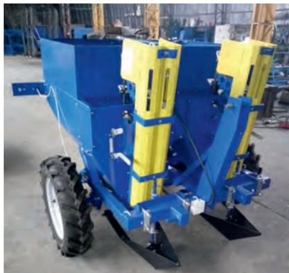
Предназначена для посадки непророщенных клубней картофеля. Загрузка картофелесажалки производится вручную. Конструкция выполнена из металла. Отсутствие пластиковых элементов в высаживающем аппарате обеспечивает надежность и долговечность.
