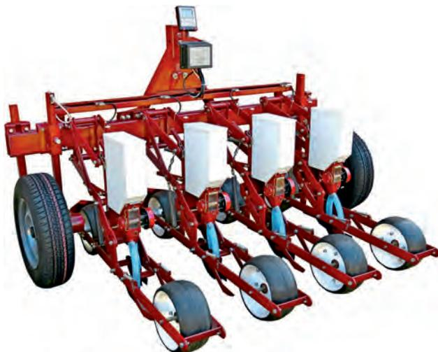
Основные узлы: рама (силовая балка) с рабочим треугольником, комплект посевных секций с бункерами и дозаторами, два опорно-приводных колеса, два гидрофицированных маркёрных устройства,
