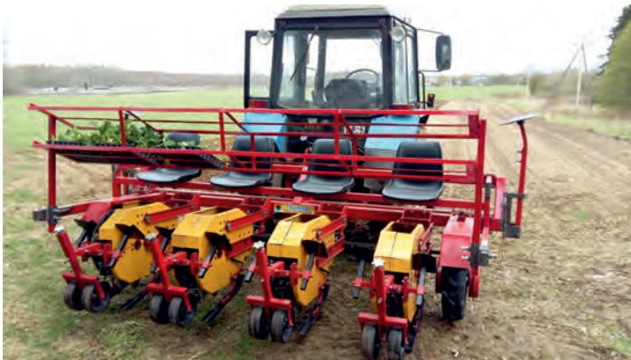
Предназначена для посадки кассетной рассады овощных культур (капуста, перец и др.) в открытый грунт из кассет с цилиндрической, конической и квадратной формами ячеек. С вертикальными высаживающими механизмами, вращение которых осуществляется двумя зубчатыми колёсами, расположенными со смещением, что обеспечивает постоянное вертикальное расположение механизмов при работе машины и исключает падение рассады набок после помещения в чашку оператором.
