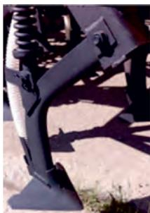
*Рис. 3.4. Лаповый сошник сеялки СКП-2.1*
