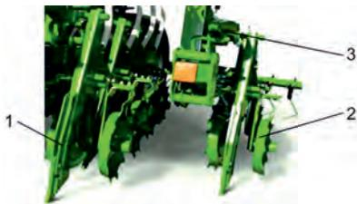
Рис. 3.2. Сошник сеялки «Amazone» Primera DMC: 1 – долотообразный сошник; 2 – каток; 3 – параллелограммный механизм
