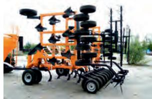
Основные составные части посевного комплекса: рама, бункер для семян и удобрений с катушкой-дозатором и вентилятором пневматической системы, передние опорные колеса, стрелчатые лапы-сошники, балансирные опорно-прикатывающие устройства с колесами, пружинная борона, пневматическая система высева семян и удобрений, загрузочный шнек, система контроля высева.
