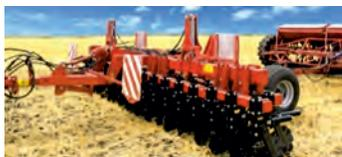
Предназначена для разрезания пожнивных остатков с раздвиганием их в стороны для возможности работы дискового сошника сеялок. Позволяет использовать традиционную сеялку в качестве сеялки прямого сева как в традиционных, так и в минимальных системах обработки почвы, в том числе и в технологии No-Till. Агрегат в составе приставки и прицепной сеялки для традиционных технологий типа СЗ 3,4 или 5,6 (или любой другой) за один проход
