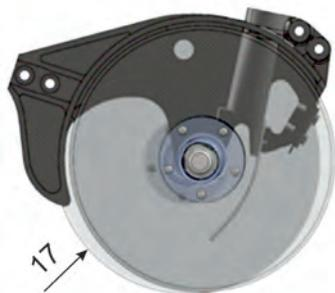
Рис. 3.6. Сошник производства «ВЕЛЕС-АГРО» (смещение 17 мм)
