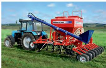
Предназначены для посева по поверхностно обработанному полю (минимальная технология), прямого посева по необработанной стерне (технология прямого посева), посева по вспаханному полю без предварительной культивации (технология комбинированного посева), посева озимых за один проход без предварительной обработки стерни. Стрельчатые лапы-сошники обрабатывают почву и формируют семенное ложе. Посевной материал поступает в распределитель, а затем по индивидуальным шлангам попадает к
