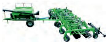
Представляет собой пневмосеялку, предназначенную для посева сельскохозяйственных культур без предварительной подготовки почвы с одновременным внесением твердых минеральных удобрений. Двухдисковые сошники с целью предотвращения их забивания установлены на раме в шахматном порядке. Перед каж-
