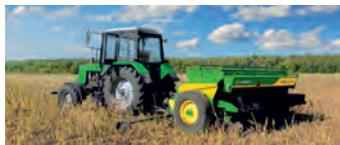
Dura-Fluted прямого посева (турбонож, колтер), обеспечивающий прорезание пожнивных остатков, создание борозды и микрообработку почвы на линии посева; двухдисковый сошник, закрепленный на параллелограммной конструкции; хвостовик-пакователь семян, прижимающий к земле каждое семя; двойные колеса, закрывающие борозду. Нагрузка на посевные корпуса регулируется сжатием пружины в четырех положениях, а также проставками, устанавливаемыми на штоки гидроцилиндров.
