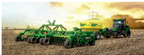
Предназначен для посева зерновых, зернобобовых, мелкосемянных культур и подсолнечника (без точной расстановки семян в рядке) по технологии прямого посева, а также по минимальной и традиционной технологиям.
