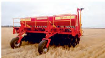
Прицепная, предназначена для посева зерновых, масличных, кормовых и других культур сплошного посева по обработанной (традиционный посев) и необработанной (прямой посев) почве. На сеялке используется система одноточечной настройки глубины, в то время как на сеялках такого же типа регулировка глубины производится для каждой отдельной секции или отдельного ряда сошников.
