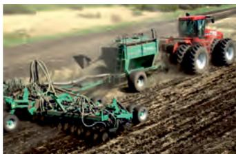
Предназначен для посева сельскохозяйственных культур без предварительной подготовки почвы с одновременным внесением твердых минеральных удобрений. Применяется в севооборотах с активным использованием почвопокровных и сидеральных культур, поскольку минимально нарушает защитный мульчирующий слой на поверхности почвы и позволяет сохранить ее естественную структуру.
