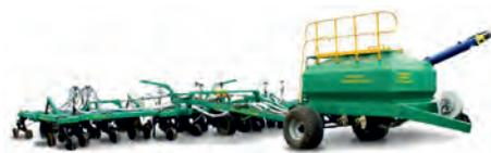
Предназначен для прямого посева зерновых, технических и масличных культур по нулевой технологии No-Till. Оснащен бункером для семенного материала и удобрений.
