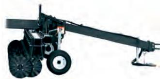
Предназначена для агрегатирования с сеялкой, не оснащённой сошниками, для прямого посева зерновых культур по беспашотной технологии или при большом количестве пожнивных остатков. Разработана для использования с сеялкой «John Deere» 1520.
