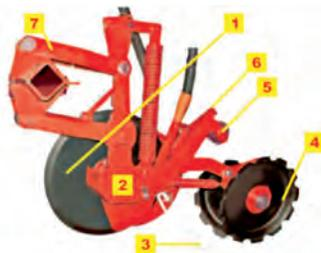
Рис. 3.10. Монодисковый сошник посевных комплексов «Turbosem»
