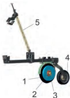
Рис. 3.7. Дискový сошник маятникового типа сеялки «Десна-Полесье» СПС-4000
