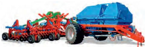
Обеспечивается возможность сева по переувлажненной почве в отличие от стерневых сеялок с однодисковым сошником.
