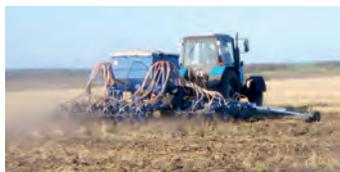
Агрегатируется с тракторами тягового класса 2,0 при посеве в необработанную и тягового класса 1,4 – в обработанную почву.
