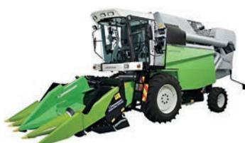
ных рельефных условиях предусмотрено включение полного привода с места водителя. Телескопическая передняя ось может менять ширину колеи с 2,55 до 3,15 м. Это гарантирует устойчивость при работе в поле с одной стороны и дает возможность перемещения техники по дорогам с другой.
