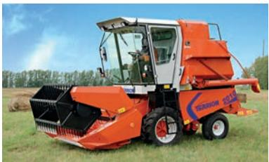
Разработан специально для опытных и селекционных участков. Оснащен очень эффективной и надежной системой самоочистки, поскольку при уборке культур с опытных и селекционных участков важно не перемешивать между собой семена разного сорта. Комбайн можно оборудовать специальными хедерами для кукурузы. Имеет гидростатическую трансмиссию и бесступенчатое регулирование скорости. Благодаря трем изменяемым диапазонам скорости машина равномерно передвигается как по опытному участку, так и трассе.
