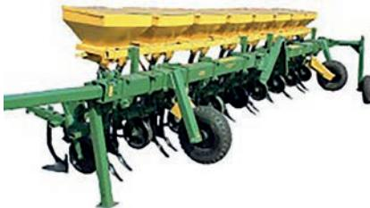
Обеспечивает качественное рыхление почвы в междурядьях на заданную глубину с уничтожением сорняков, а параллелограммная подвеска секций рабочих органов – копирование рельефа почвы, шины атмосферного давления и обрезиненные катки культиватора способствуют самоочистке от налипшей грязи. Предусмотрен вариант применения культиватора для сплошной культивации с использованием плоскорежущих односторонних лап. Наличие транспортного устройства позволяет транспортировать его по дорогам общего назначения.
