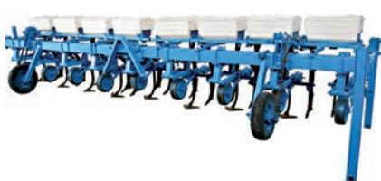
Предназначен для междуурядной обработки 8- и 12-рядных посевов кукурузы, высеванных с междуурядьями 450-700 мм и более во всех почвенно-климатических зонах, исключая районы с каменистыми почвами. КМН (КРН) в зависимости от установленных рабочих органов, приспособлений и схемы их установки может выполнять следующие операции: подрезание сорной растительности и рыхление почвы в междууряд-
