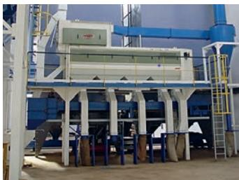
Предназначен для очистки и калибровки зерна, в том числе кукурузы, различных модификаций. Сортируют зерно по размеру – цилиндрическими барабанами с ячейками. Точность сортировки обеспечивается барабаном с регулируемым наклоном и частотой вращения. Выбор оборудования обусловлен количеством обрабатываемого материала и требуемой производительностью. Первый показатель определяет число требуемых секций (от 3 до 5), второй – диаметр барабана (от 630 до 1610 мм).
