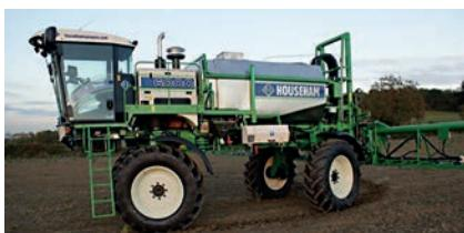
Househam Air Ride 3000 имеет бак, изготовленный из армированного стекловолокна. Оснащен системой Air Ride, которая обеспечивает плавное движение опрыскивателя по неровным полям и дорогам на маленьких и больших скоростях. Комплектуется разными вариантами штанг – 12/24 м, а также 28,32,36 м опционно. Имеет возможность изменять ширину колеи.
