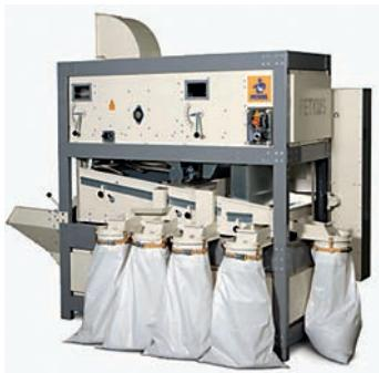
Состоят из загрузочного бункера, канала первичной и вторичной сепарации с отстойными камерами, решетного стана с двумя решетными плоскостями и двумя параллельно работающими триерами. Привод различных компонентов (питающее устройство, решетный стан, вентилятор и т.д.) осуществляется с помощью системы клиновидных ремней с электромотором. При очистке кукурузы триеры отключают.
