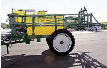
которые хорошо видны из кабины трактора. Агрегатируется с тракторами тягового класса 1,4.
