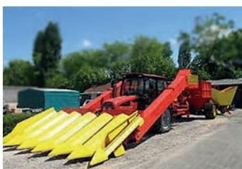
Навесной с прицепным бункером, предназначен для уборки кукурузы на зерно. Представляет собой новое техническо-технологическое решение в сфере сборщиков кукурузы. Одно из преимуществ – в предуборочный и послеборочный периоды полуприцеп, агрегатированный с трактором, можно использовать как самостоятельное транспортное перегрузочное средство для перегрузки сельскохозяйственных грузов непосредственно в вагоны, полу-вагоны и кузов автомобиля.
