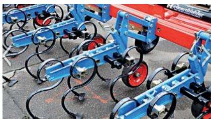
Оборудован системой автоматического подруливания, которая реализована следующим образом: расположенные по бокам управляющие диски связаны с буксиром посредством рычажного механизма в точке соединения верхней тяги, благодаря чему культиватор точно следует за управляющими движениями трактора. Это позволяет избежать «подрезания» рядка на уклонах, что способствует выполнению культивации достаточно близко от рядов.
