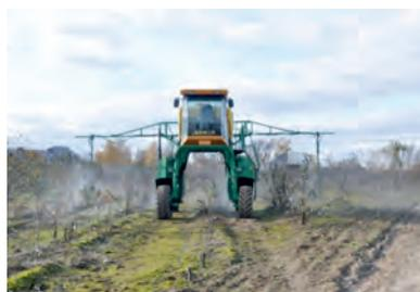
*Внесение средств химической защиты растений высококлиренсным опрыскивателем-гербицидным комом на базе СУВЭС*
