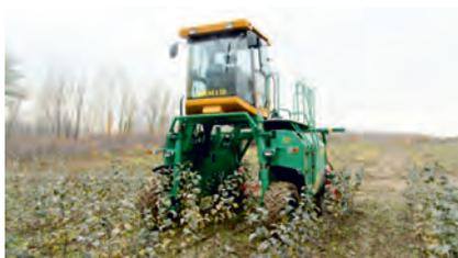
*Самоходное высококлиренсное энергосредство (СУВЭС) с интеллектуальной системой управления для агрегатирования технологических адаптеров*
