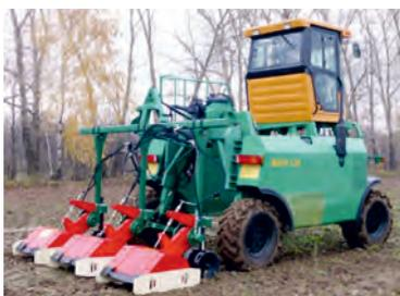
*Фрезерование междурядий высококлиренсным культиватором фрезерного типа на базе СУВЭС*
