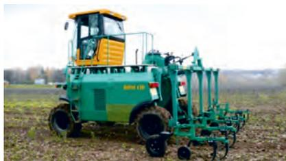
*Обработка почвы в междурядьях высококлиренсным пропашным культиватором на базе СУВЭС*
