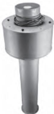
Для подключения озонаторов (рис. 2) в хранилище следует предусмотреть соответствующие коммутационные устройства для дистанционного управления ими, контроля концентрации озона в объеме хранилища и при необходимости контроля качества сохранности продукции. Наилучший способ установки озонаторов – подключение их к входу вентиляторов, имеющих соответствующие шиберы, или непосредственно в вентиляционную камеру.
