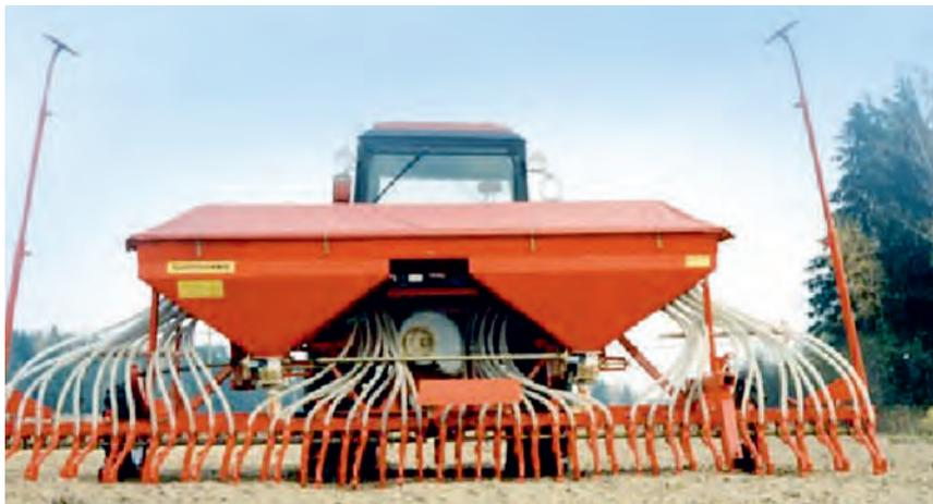
Рис. 2.2. Сеялка СПУ-6Л для высева льна
