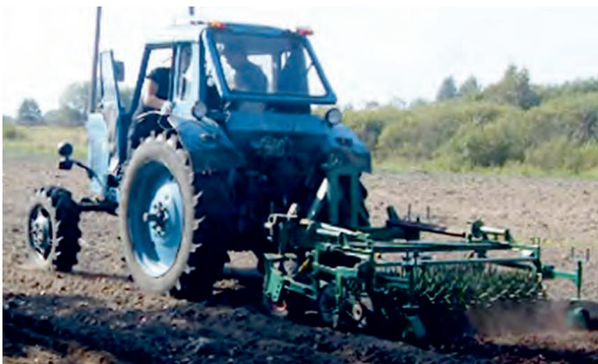
*Рис. 2.1. Общий вид игольчатой бороны БИ-1,5 (в работе)*
