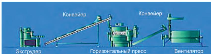
Рис. 12. Схема процесса отжима соевого масла по технологии компании «INSTA-PRO ЭксПресс™»
