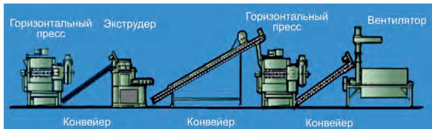
Рис. 13. Схема процесса отжима рапсового масла по технологии компании «INSTA-PRO Экспресс™»
