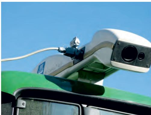
*Рис. 11. Сканирующая система N-Sensor, установленная на кабине трактора*
