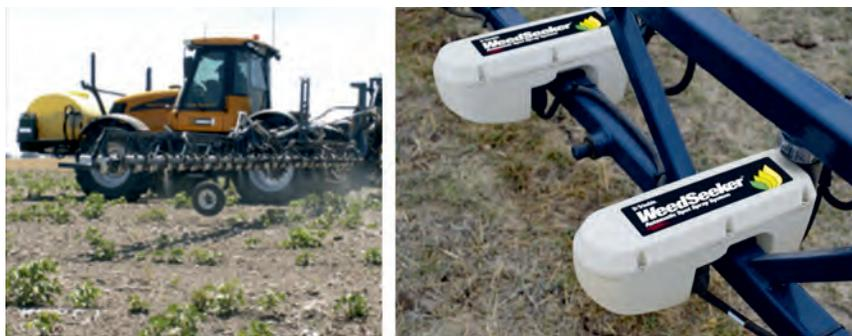
*Рис. 12. Система автоматической детекции и опрыскивания сорняков WeedSeeker*
