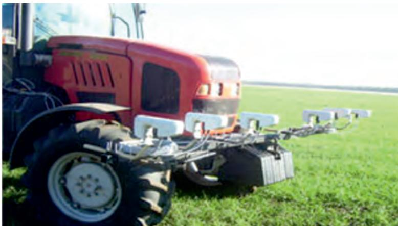
*Рис. 10. Установка GreenSeeker на передней навеске трактора*
