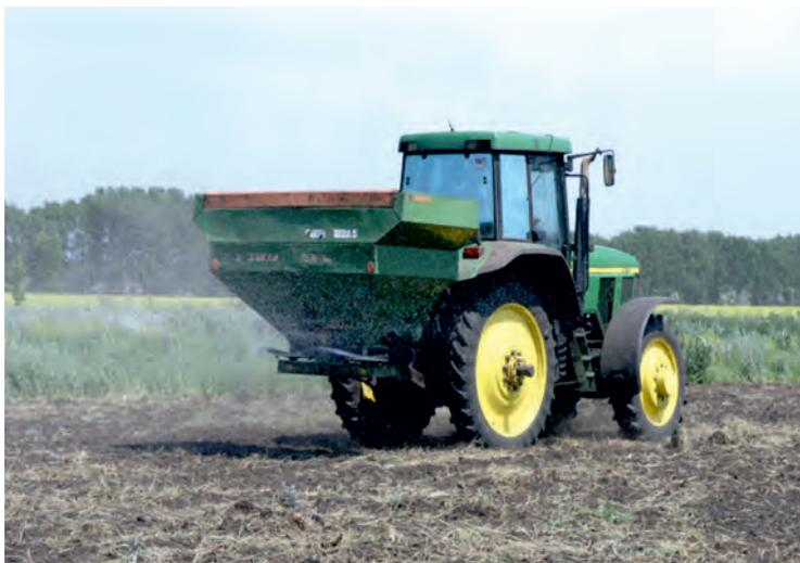
*Рис. 5. Навесной разбрасыватель минеральных удобрений РА 900*
