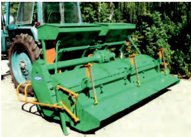
*Рис. 8. Культиватор для дробно-локального внесения минеральных удобрений с фрезерной обработкой почвы для междурядий 90 см (совместная разработка ФГБНУ «ФИЦ картофеля имени А.Г. Лорха» и ИТОСХ – филиал ФГБНУ ФНАЦ ВИМ)*
