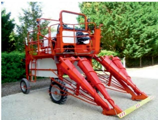
*Рис. 2.7. Высококлиренсный трактор компании «Baural»*
