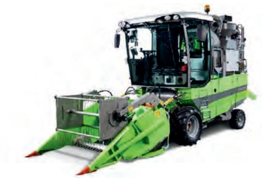
Рис. 4.6. Селекционный комбайн «Quantum»
