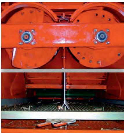
*Рис. 4.21. Осевые роторы молотилки*
