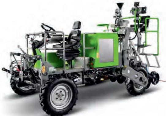
*Рис. 2.3. Самоходное шасси Tool Carrier*
