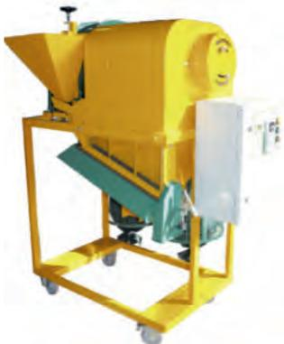
*Рис. 5.5. Пневмосортировальная машина ВИМ-1 Селекция*
