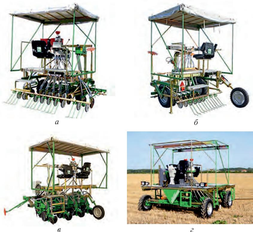
Рис. 3.12. Селекционные сеялки SB-25 (а), SR-30 (б), SP-35 (в) и SD-50 (г)
