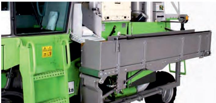
*Рис. 4.10. Ленточный транспортер для проб*
