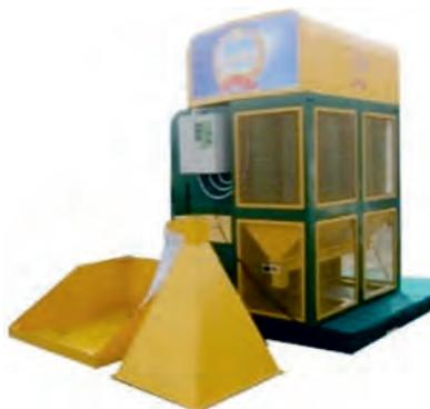
*Рис. 5.4. Гравитационно-пневматический зерно-семяочиститель ВИМ-3*
