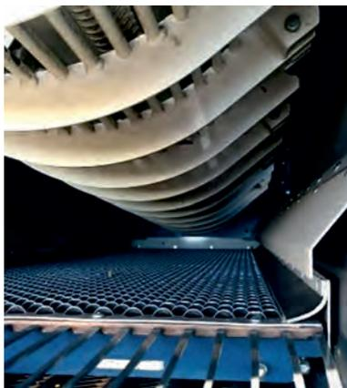
*Рис. 4.19. Ротор и система очистки комбайна R1*
