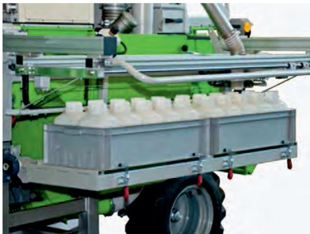
*Рис. 4.9. Устройство затаривания в контейнеры на салазках*
