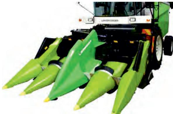
*Рис. 4.13. Гидравлически складываемая жатка*
