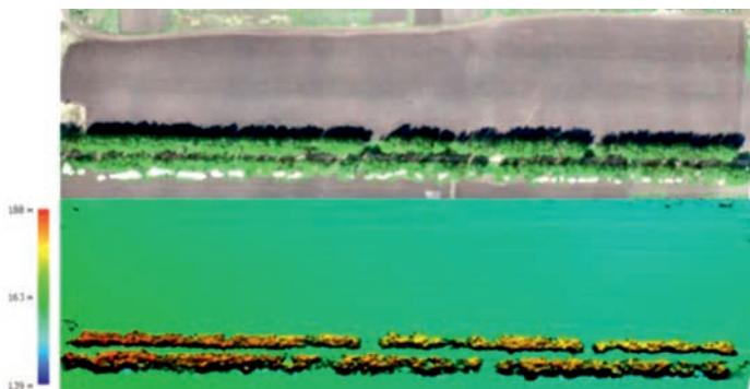
*Рис. 19. Ортофотоплан и цифровая модель поверхности*
