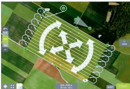
*Рис. 13. План полета БПЛА в приложении Pix4Dcapture*
