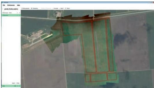
*Рис. 15 Результат построения ортофотоплана и границы полей, введенные пользователем*
