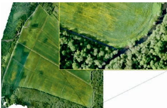
*Рис. 7. Фрагмент неработающего водоприемника, в котором наблюдается застой воды*
