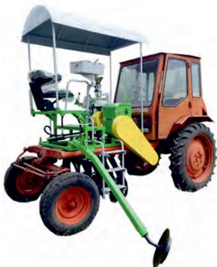
Предназначена для рядового посева семян зерновых, зернобобовых и крупяных культур на втором и третьем этапах селекции в зонах неорошаемого земледелия. Оборудована аппаратом порционного высева, высевающим без остатка порцию семян заданной массы на необходимую длину делянки (от 1 до 20 м). Монтируется на раме самоходного шасси Т-16. Обеспечивает качественный посев на полях, подготовленных в соответствии с агротехническими требованиями СТО АИСТ 105.6-2003.
