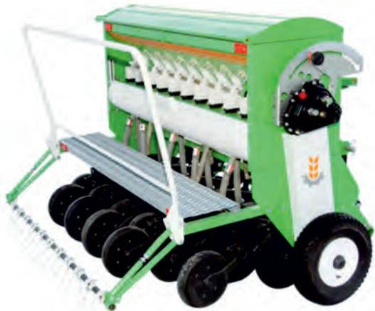
Агрегатируется с тракторами класса 0,6-1,4 (Т-25, Т-40М, МТЗ-80, МТЗ-82, ЮМЗ-6АЛ) с расширенной до 2 м колесей, оборудованными гидрофицированной навесной системой. Колеса трактора, двигаясь по межпосевным дорожкам, не уплотняют почву на опытной делянке.
