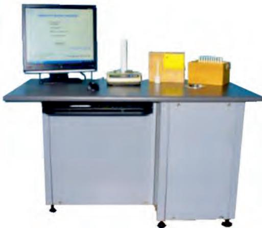
Включает в себя персональный компьютер и полуавтоматическое взвешивающее устройство. В анализаторе реализованы режим автоматической коррекции результатов измерения в зависимости от изменения параметров внешней среды и режим полуавтоматической градуировки по стандартным образцам. Управление работой и обработка результатов измерения осуществляются по специальной программе, адаптированной к операционной системе Windows XP,
