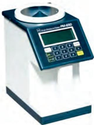
Влагомеры фирмы «Kett» выпускаются в следующих модификациях: РМ-400 (РМ-410, РМ-450), РМ-600 (РМ-600, РМ 650), которые отличаются перечнем анализируемых материалов и незначительными отклонениями весовых и габаритных характеристик. В них реализован диэлькометрический (емкостный) метод измерений влажности.
