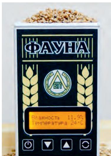
Предназначен для измерения влажности (массовой доли влаги) зерновых, зернобобовых, масличных культур и семян трав, а также продуктов их переработки. Используется при сушке, уборке и хранении, а также переработке культур на предприятиях, где необходим экспресс-анализ влажности отобранных проб. Представляет собой микропроцессорный прибор.
