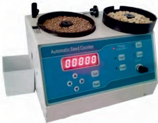
Благодаря регулируемой интенсивности вибрации зерна двигаются по спиралевидному каналу кассеты. На выходе из кассеты они проходят через новейший инфракрасный датчик, с помощью которого осуществляется подсчет. По достижении нужного количества зерен вибрация отключается и отсчет прекращается.
