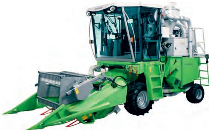
Благодаря модульной конструкции переоборудуется под различные варианты уборки. Данная модель обладает высокой производительностью, эффективной молотилкой, двухступенчатым соломотрясом с плоскими решетками, системой двойной очистки зерна. Для удобства управления агрегат оснащен многофункциональным рычагом, гидросилителем руля и гидростатическим приводом колес. Современная кабина с удобной приборной панелью, кондиционером и качественной звукоизоляцией обеспечивает комфортную эксплуатацию.
