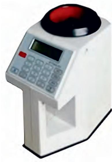
Предназначен для измерения влажности, натуре и температуры зерновых культур (пшеницы, ржи, ячменя, овса, гречихи), зернобобовых (кукурузы, гороха), семян масличных и овощных культур, применяется в лабораторных и полевых условиях в процессе уборки, обработки, хранения и приемки зерна и семян.
