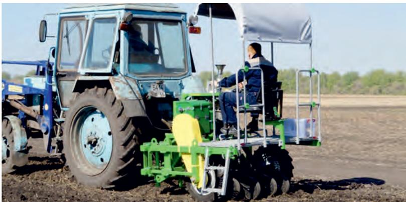
Оборудована высевающим аппаратом порционного высева, высевающим без остатка порцию семян заданной массы на необходимую длину деланки от 0,5 до 32 м. Обеспечивает качественный посев на полях, подготовленных в соответствии с агротехническими требованиями СТО АИСТ 5.6-2010.
