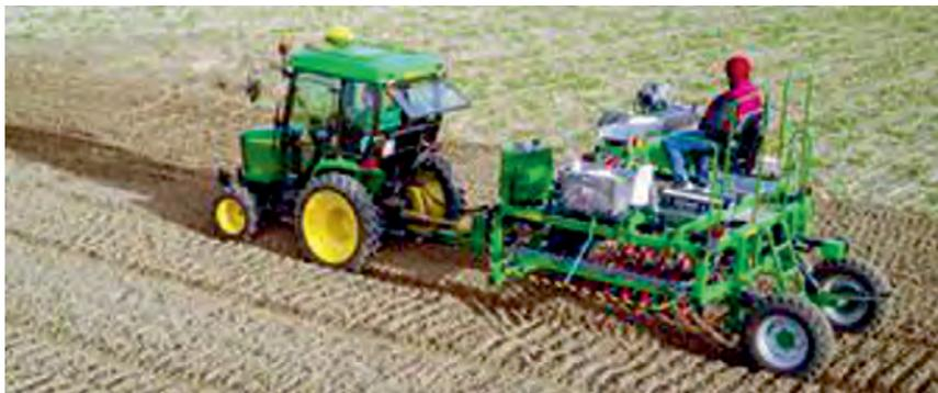
Фирмой «Zürn Harvesting GmbH & Co KG» выпускаются также селекционные сеялки мод. ZÜRN D62 (рабочая ширина от 1,25 до 2,0 м; до 14 рядов), ZÜRN D84 для сева на микроделянках, однорядные сеялки ZÜRN D90 и сеялки с отдельными посевными рядами ZÜRN D92. Все перечисленные сеялки сконструированы по модульному принципу.
