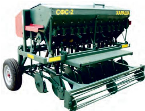
Предназначена для посева зерновых, бобовых, крупяных и мелкосеменных культур с внесением удобрений. Навесная, механическая, оснащена системой закрытых дорожек, гидравлическими маркерами, дисковыми сошниками, заделывающими боронками. Позволяет проводить посев после боронования без культивации при влаж-
