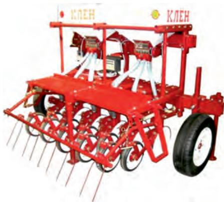
Навесная, предназначена для рядового посева семян зерновых, зернобобовых, крупяных культур и трав на участках предварительного и производственного конкурсного сорто-испытания, а также для проведения агротехнических опытов и посевов размножения.
