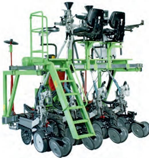
Подача семенного материала может осуществляться раздельным способом (одна загрузочная воронка на каждый ряд) или с использованием центрального дозатора посевного материала (семена одного сорта распределяются по всем рядкам делянки), кассетного стола (семена засыпаются в четырех- или шестирядные кассеты), устройства продолжительного посева (зерновые ящики емкостью 6 л на каждый ряд).
