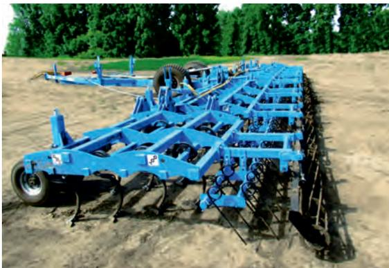
Рис. 6.6. Культиватор секционный универсальный КСУ-15 «Алтай»
