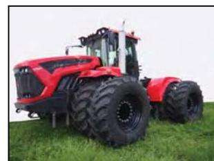
Трактор "Кировец" К-730М Стандарт 1 со сдвоенными колесами
