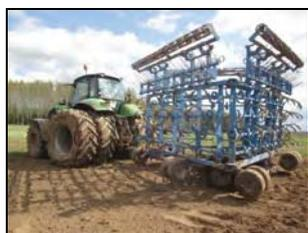
Культиватор полуприцепной КБМ-11-4П-Ш1К-ВС в агрегате с трактором Джон Дир 7830 в транспортном положении
