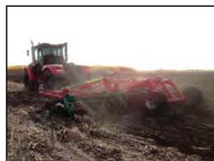
Борона дисковая модернизированная марки "Диас" модель: БДМ-7×4ПК-ШКС в агрегате с трактором К-742МСт1 на дисковании пожнивных остатков подсолнечника
