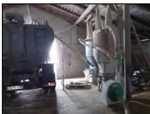
Дробилка роторная ДКР-4 на измельчении зерна ячменя в линии с двумя бункерами-смесителями ССК
