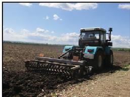
Трактор сельскохозяйственный колесный общего назначения БТЗ-243К.20, в агрегате с плугом цизельным ПЧН-3 на безотвальной обработке почвы (чизелевании)
