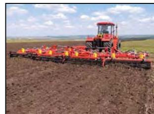
Культиватор "Landmaster-9800" в агрегате с трактором Т-360 на предпосевной обработке почвы
