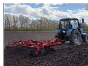
Культиватор Полярис-4 в агрегате с трактором Беларус-892 на предпосевной обработке почвы
