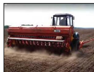
Сеялка зерновая модели ЗС-4,2 в агрегате с трактором Беларусь 82.1 на посеве ячменя
