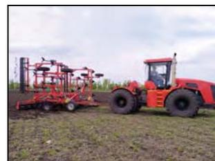
Культиватор "Landmaster-9800" в агрегате с трактором Т-360 в транспортном положении
