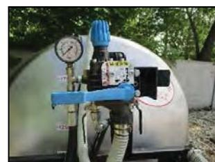
Нагнетательная система регулировки давления
