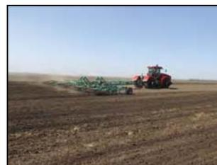
Культиватор КПП-14,5 в агрегате с трактором К-742 МГр, на предпосевной культивации
