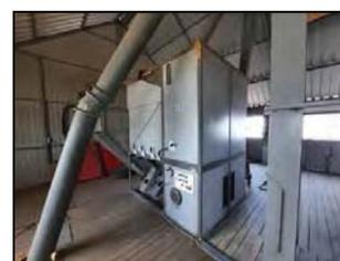
Машина сепарирующая МС-40/20 в рабочей линии
