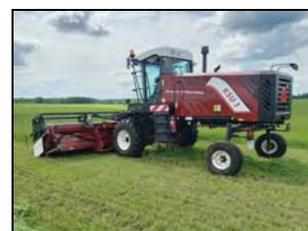
Косилка валковая транспортерная КВТ 7-14 "Draper Flow 700" совместно с шасси самоходным для уборочных машин ШС-150 на скашивании трав и укладке срезанной массы в центральный валок
