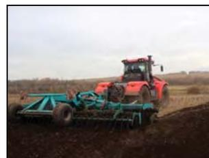
Луцильник дисковый тяжелый полуприцепной складной М-7000ПС М "Мастер" в агрегате с трактором К-742МПР, на измельчении и заделке растительных остатков после уборки подсолнечника
