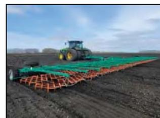
Борона гидрофицированная универсальная БГУ-20-3 "Кузбасс" в агрегате с трактором John Deere 8310R на весеннем закрытии влаги
