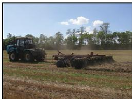
Трактор сельскохозяйственный колесный общего назначения БТЗ-243К.20 в агрегате с боронной дисковой DV 1000/600 на дисковом лущении стерни озимой пшеницы
