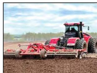
Борона дисковая торговой марки "Solar Fields" серии ЛД модель ЛД-8ПК-01.00 EURO в агрегате с трактором К-742М
