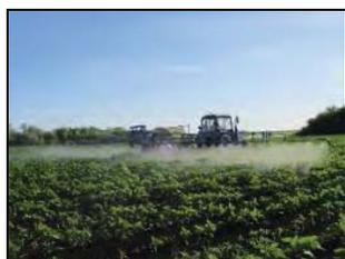
Опрыскиватель полуприцепной штанговый ОП-22-2500 в агрегате с трактором Беларус 82. на внесении жидких минеральных удобрений под подсолнечник
