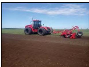
ДПМ-6000 "Универсал" в агрегате с трактором К-742МСт на обработке почвы парового поля
