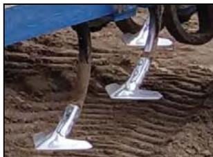
Рабочие органы культиватора – S-образные стойки со стрелчатыми лапами
