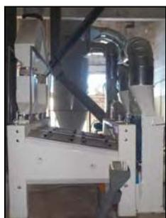
Сепаратор зерноочистительный А1-БИС-100
