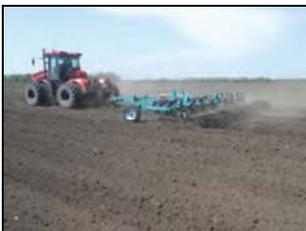
Колесный сельскохозяйственный трактор "Кировец" К-525М Премиум со сдвоенными колесами в агрегате с культиватором КСОП-8 на предпосевной культивации
