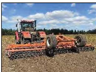
Борона дисковая складная БДС-8×2П в агрегате с трактором К-739МС1 на основной обработке почвы
