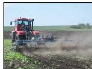
Культиватор полуприцепной торговой марки "TIGARBO", модель КПП-7,5 в агрегате с трактором Кировец К4 на культивации пара
