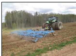
Культиватор полуприцепной КБМ-11-4П-Ш1К-ВС в агрегате с трактором Джон Дир 7830 на культивации с целью рыхления поверхностного слоя почвы
