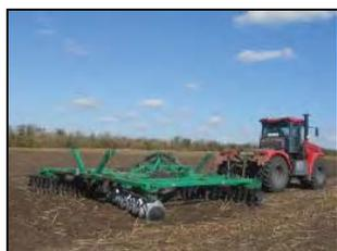
Борона дисковая тяжелая БД-6,6М в агрегате с трактором "Кировец" К-744Р4 "Премиум" на дисковании стерни подсолнечника
