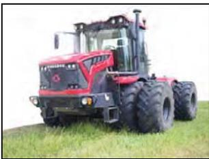
Колесный сельскохозяйственный трактор "Кировец" К-525М Премиум со сдвоенными колесами
