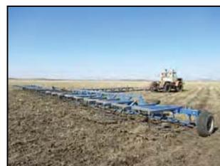
Сцепка бороновальная широкозахватная гидрофицированная СШГ-22У в агрегате с трактором Т-150К на весеннем закрытии влаги
