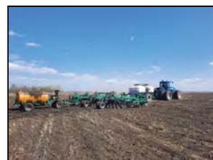
Посевной комплекс "Кузбасс-Т" ПК-12,2 в агрегате с трактором New Holland T9040 и установкой для внесения жидких удобрений "УЖУ" на посевах яровой пшеницы
