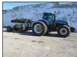
Почвообрабатывающий агрегат выравнивающий ПАВ-6.М в агрегате с трактором New Holland T7060 в транспортном положении
