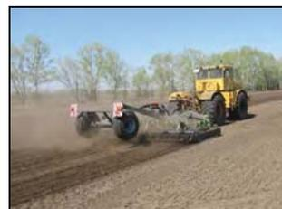
Почвообрабатывающий агрегат выравнивающий ПАВ-6.М в агрегате с трактором К-701, на предпосевной обработке почвы
