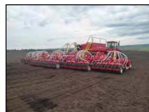
Дисковый посевной комплекс "Agrator Disk-15000" в агрегате с трактором Т-360 на посеве яровой пшеницы
