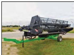
Жатка зерновая валковая транспортерная SH-309 на транспортной тележке
