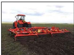
Культиватор "Landmaster-8500" в агрегате с трактором Т-360 на предпосевной обработке почвы
