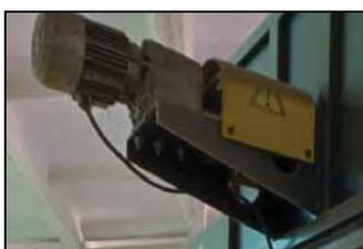
Мотор-редуктор машины зерноочистительной универсальной МЗК-7С
