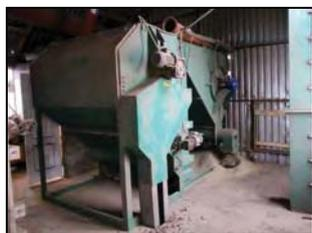
Машина предварительной очистки зерна МПОЗ-80 в составе технологической линии зерноочистительного комплекса
