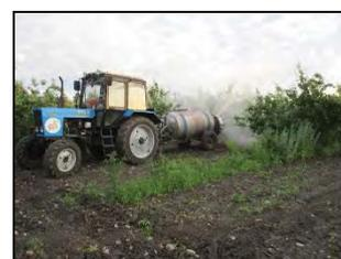
Опрыскиватель вентиляторный полуприцепной ОВС-2000 в агрегате с трактором Беларус 82.1 на обработке сада
