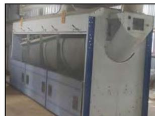
Скальператор для предварительной очистки зерна марки А1-БЗО исп.6 на предварительной очистке озимой пшеницы
