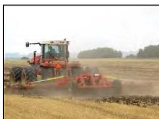
Борона дисковая модернизированная марки "Диас" БДМ-8×3ПК-ШКС в агрегате с трактором Versatile 2375 на дисковом лущении стерни озимой пшеницы
