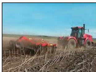
Борона дисковая модернизированная марки "Диас" БДМ-8×3ПК-ШКС в агрегате с трактором К-744Р3 на дисковом лущении пожнивных остатков подсолнечника
