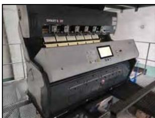
Фотосепаратор СмартСорт 6 (С+СN) в рабочей линии
