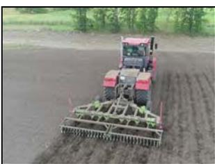
Плуг чизельный ПЧ-4,5Ч в агрегате с трактором К-744Р4 на обработке пара
