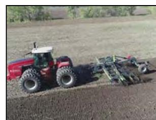
Борона дисковая полуприцепная БДП-6 в агрегате с трактором Versatile 2375 на измельчении пожнивных остатков крупностебельных культур
