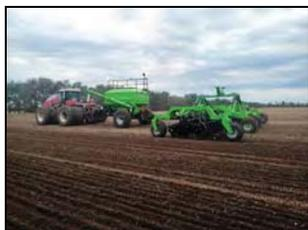
Сеялка зернотуковая прямого посева Дон 651-М1 в агрегате с трактором РСМ-2400 на посеве озимой пшеницы
