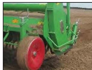
Опорное колесо с механизмом регулировки глубины обработки
