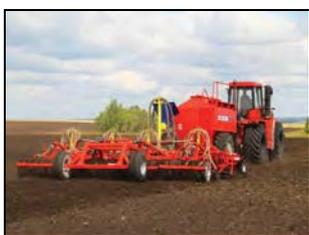
Пневматический посевной комплекс Agrator-9800 в агрегате с трактором Т-360Ш на посеве яровой пшеницы сорта "Тулайковская 108"
