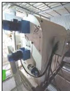
Аспиратор с замкнутым циклом воздуха Р1-БДЗ-50 на очистке зерна от аэродинамических легких примесей
