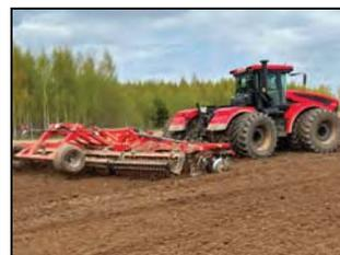
Борона дисковая торговой марки "Solar Fields" серии ЛД модель ЛД-8ПК-01.00 EURO в агрегате с трактором К-742М на предпосевной подготовке поля
