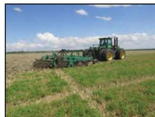
Борона дисковая тяжелая БДУ-6,4 в агрегате с трактором John Deere 9430 на дисковом лущении стерни озимой пшеницы (1 след)
