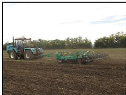
Трактор сельскохозяйственный колесный общего назначения БТЗ-243К.20 в агрегате с культиватором КПУ-8ПЕ на предпосевной культивации
