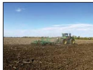
Борона дисковая тяжелая БДУ-6,4 в агрегате с трактором John Deere 9430 на дисковом лущении пожнивных остатков подсолнечника (1 след)
