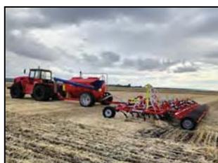
Анкерный посевной комплекс "Agrator Ancer-9800" в агрегате с трактором Т-360 на посеве яровой пшеницы
