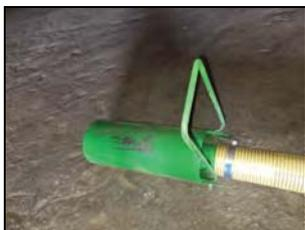
Эжектор всасывающего трубопровода
