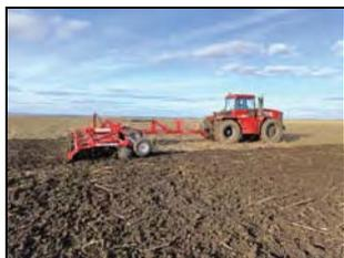
Широкозахватный дисковый агрегат "Megadisk-9000" в агрегате с трактором Т-360 на измельчении пожнивных остатков подсолнечника
