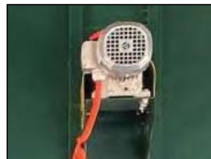
Мотор-редуктор машины зерноочистительной универсальной МЗК-50
