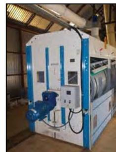
Скальператор для предварительной очистки зерна марки А1-БЗО исп. 6
