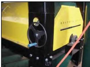
Механизм поворота лотка цилиндра блока триерного БТ-7Т
