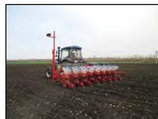
Сеялка пневматическая точного высева тип ТС-М модель 8000А в агрегате с трактором LOVOL 1304 на посевах кукурузы
