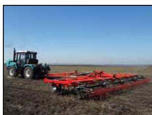
Культиватор сплошной торговой марки "Solar Fields" серии КС, модель КС-10 (У)-01.00 EURO в агрегате с трактором БТЗ-243К на сплошной культивации пара
