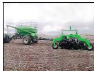
Сеялка зернотуковая прямого посева Дон 637 на посеве яровой пшеницы с одновременным внесением удобрений
