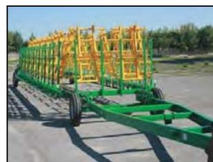
Борона пружинная гидрофицированная БПГ-24 с секциями пружинных борон в транспортном положении
