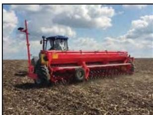
Сеялка зерновая модель ЗС-6 на посеве яровой пшеницы с одновременным внесением удобрений
