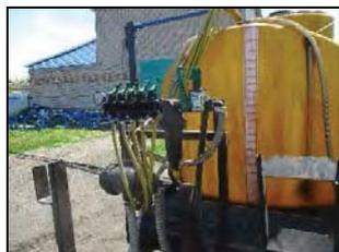
Нагнетательная система регулировки давления
