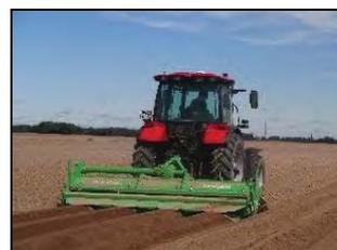
Культиватор-гребнеобразователь Иксион 4×90 в агрегате с трактором Беларус 1523.3 на рыхлении почвы
