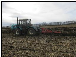
Трактор сельскохозяйственный колесный общего назначения БТЗ-243К.20 в агрегате с плугом ПС 5/50 на отвальной обработке почвы
