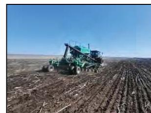
Посевной комплекс "Томь" ПК-6,3Б в агрегате с трактором Беларус 1523.3 на посеве озимой пшеницы
