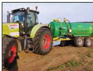
Машина для внесения жидких органических удобрений МЖ-11 в агрегате с трактором CLAAS 85
