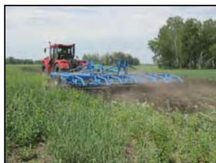
Борона дисковая тяжелая "Звезда" БДТ-7,62 в агрегате с трактором К-744Р4 на обработке пара
