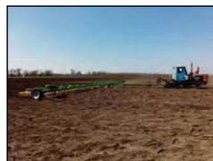
Борона пружинная гидрофицированная БПГ-24 в агрегате с трактором Т-150 на бороновании зяби
