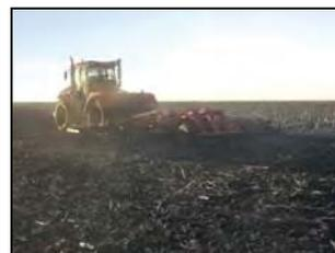
Борона дисковая модернизированная марки "Диас" БДМ-9×2ПК-Д-ШКС в агрегате с трактором К-742МСт1 на дисковом лущении пожнивных остатков подсолнечника
