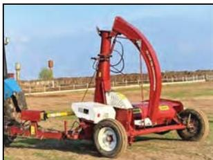
Комбайн кормоуборочный полуприцепной КСД-2,0 в агрегате с трактором МТЗ-82
