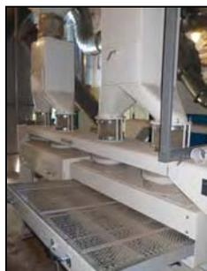
Сепаратор зерноочистительный А1-БИС-100, решетная рамка
