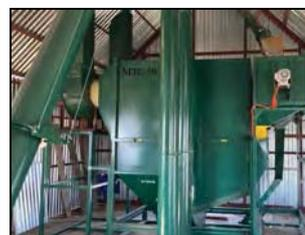
Машина зерноочистительная универсальная МЗК-50 в составе модернизированного зерноочистительного агрегата ЗАВ-25М
