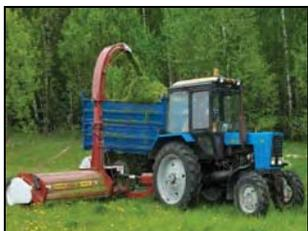
Комбайн кормоуборочный полуприцепной КСД-2,0 в агрегате с трактором МТЗ-82,1 на скашивании и измельчении с подачей массы в транспортное средство злаковой смеси
