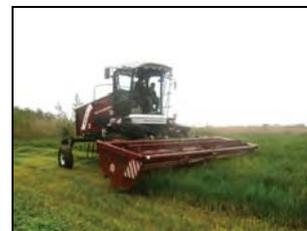
Косилка-плющилка GM-500-02 в агрегате с шасси самоходным для уборочных машин (энергосредством) ШС-150 на скашивании с плющением люцерны
