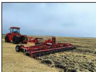
Широкозахватный дисковый агрегат "Megadisk-9000" в агрегате с трактором Т-360, на дисковании стерни яровой пшеницы
