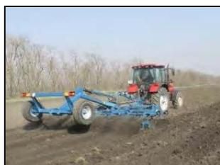
Культиватор предпосевной торговой марки "TIGARBO", модель КПП-6, в агрегате с трактором Беларус-1523 на сплошной культивации
