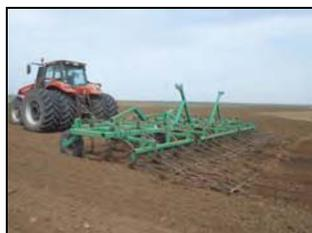
Культиватор паровой предпосевной КТП-9,4М в агрегате с трактором CASE IH MAGNUM 310 на культивации пара
