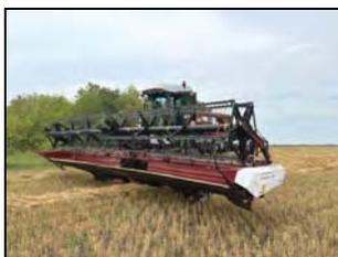
Косилка валковая транспортерная КВТ-2 "Draper Flow 1050" в агрегате с косилкой самоходной универсальной КСУ-2
