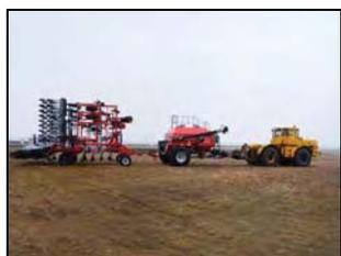
Комбинированный посевной комплекс FEATAGRO D-9900 в агрегате с трактором "Кировец" К-701 в транспортном положении
