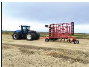
Дискокультиватор "Combimaster-8000" в агрегате с трактором NEW HOLLAND T9.505 в транспортном положении
