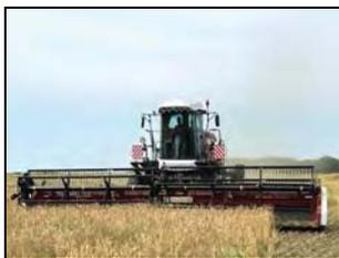
Косилка валковая транспортерная КВТ-2 "Draper Flow 1050" в агрегате с косилкой самоходной универсальной КСУ-2 на скашивании в валки ярового ячменя
