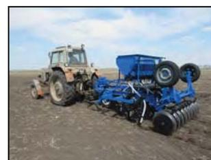
Сеялка-культиватор зернотуковая для полосного посева СКП-2,1Г.У в агрегате с трактором МТЗ-80 на посеве пшеницы
