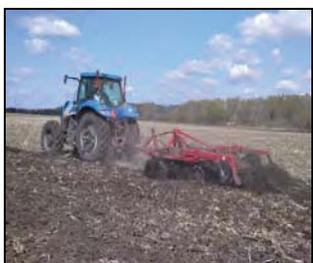
Борона дисковая модульная прицепная БДМП-3×4 в агрегате с трактором New Holland – Т8040 на дисковании почвы с измельчением пожнивных остатков кукурузы
