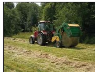
Пресс-подборщик рулонный ПРФ-145 в агрегате с трактором МТЗ-1021.5 на прессовании сена с обмоткой шпагатом
