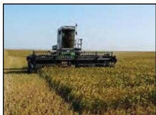
Жатка зерновая валковая транспортерная SH-309 в агрегате с косилкой "Мещера Е-403" на скашивании в валки ярового ячменя
