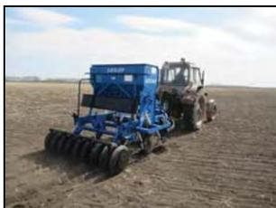
Сеялка-культиватор зернотуковая для полосного посева СКП-2,1Б.У в агрегате с трактором МТЗ-80 на посевах пшеницы
