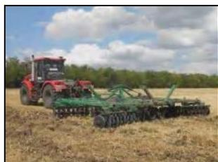
Борона дисковая тяжелая БД-6,6М в агрегате с трактором "Кировец" К-744Р4 "Премиум" на дисковании стерни ярового ячменя
