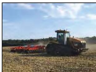
Агрегат диско-чизельный универсальный АДУ-54 в агрегате с трактором CHALLENGER MT 865 9 на одновременном глубоком и поверхностном рыхлении почвы
