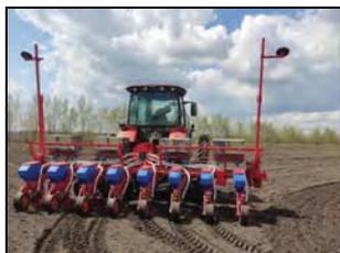
Сеялка пневматическая точного высева тип ТС-М модель 4150А на посеве яровой пшеницы с одновременным внесением удобрений
