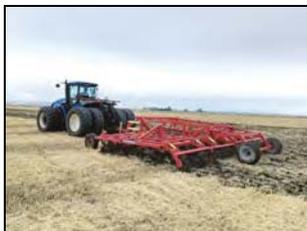
Дискокультиватор "Combimaster-8000" в агрегате с трактором NEW HOLLAND T9.505 на основной обработке почвы по стерне яровой пшеницы
