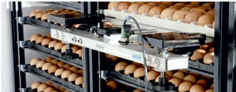
*Рис. 15. Система Dynamic Weight Loss System™ (DWLS™)*
