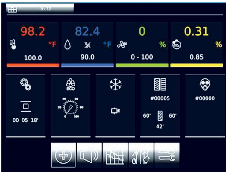
Рис. 17. Жидкокристаллический экран с высоким разрешением и сенсорной клавиатурой системы IrisPlus™
