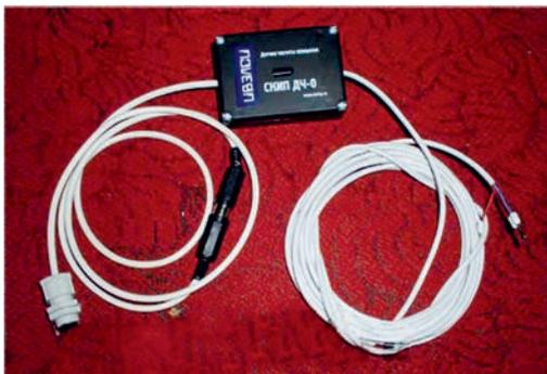
*Рис. 7. Датчик частоты вращения вентилятора для инкубаторов ЗАО «Востокптицемаи»*
