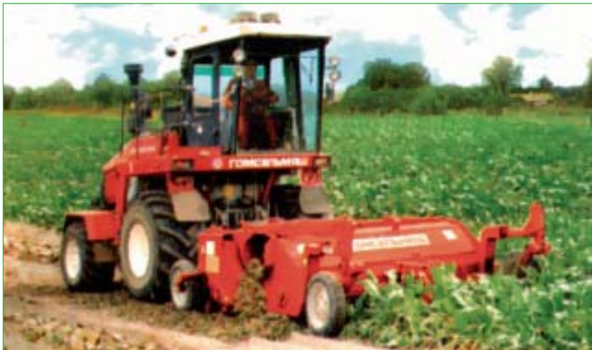
Рис. 1. Универсальное энергосредство УЭС-2-250А с навесным комбайном КСН-6
