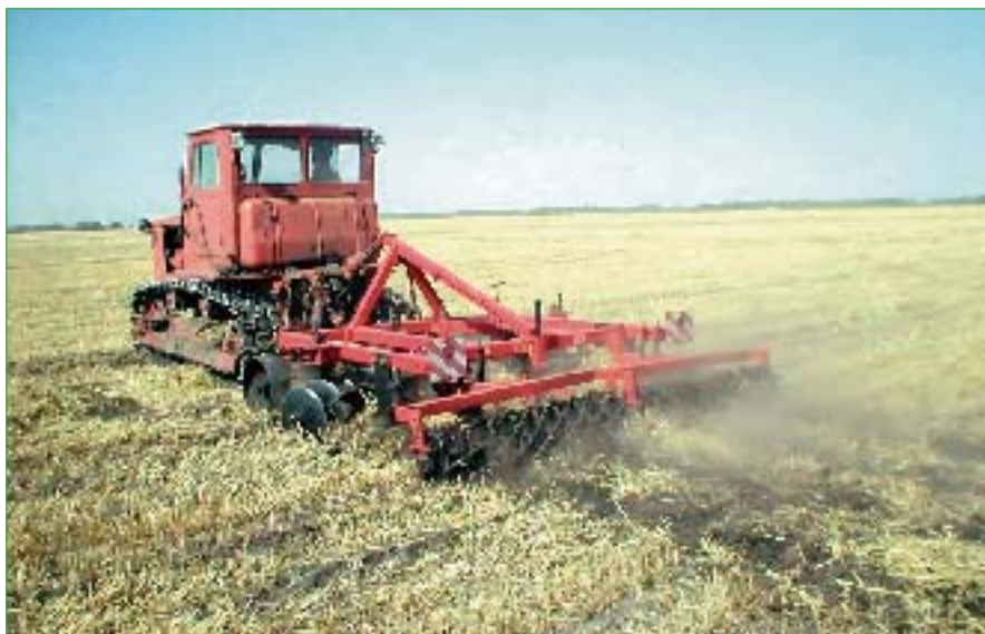
Рис. 2. Плоскорезная обработка почвы агрегатом АПК-3
