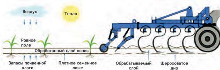
Рис. 2. Технологический процесс предпосевной обработки почвы культиваторами КБМ
