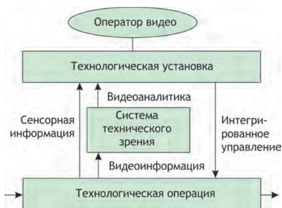
Рис. 1. Схема интеграции управления технологической операцией с системой технического зрения
