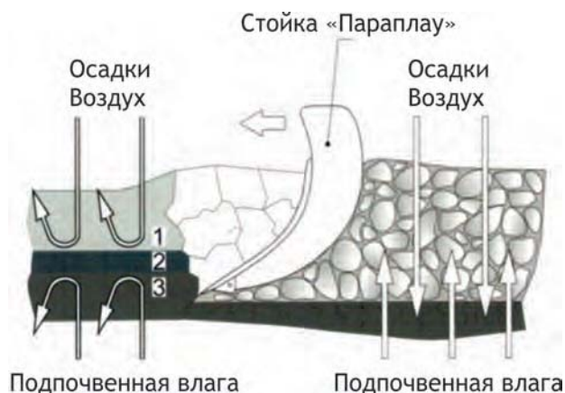
Рис. 1. Технологический процесс обработки почвы глуборыхлителем (схема разрушения плужной подошвы):
