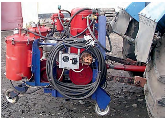
**Рис. 2. Экспериментальный агрегат УЛН-03 для нанесения вязких защитных составов**
