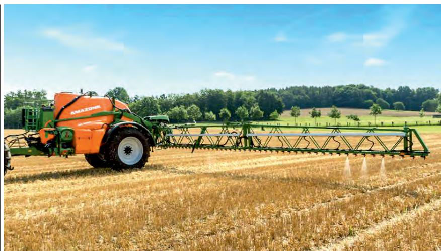
**Рис. 1.** Прицепной опрыскиватель UX AmaSpot с интеллектуальной системой сенсорных форсунок для дифференцированного внесения средств защиты растений
