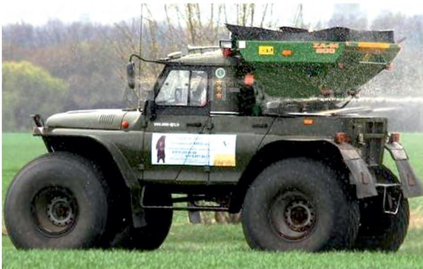
**Рис. 1.** Тукоразбрасыватель AMAZONE ZA-M900 на базе вездехода УАЗ-469
