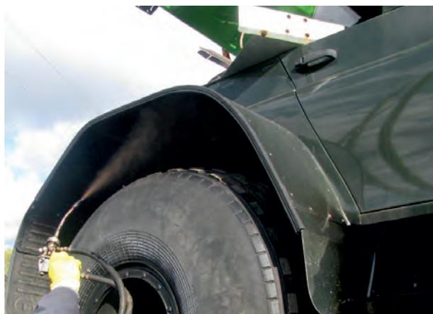
**Рис. 3. Рабочий процесс нанесения консервационного покрытия на арки задних колес самоходного разбрасывателя минеральных удобрений**
