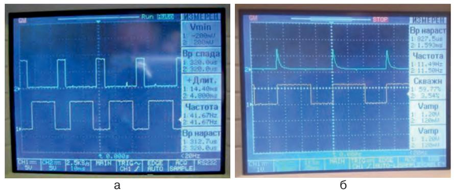
Рис. 5. Осциллограммы сигналов управления электронными ключами (а, поз. 1, 2), сигнала управления (б, поз. 1) и импульсов магнитной индукции, излучаемых индуктором «Е» ПСИ-1Л (б, поз. 2)
