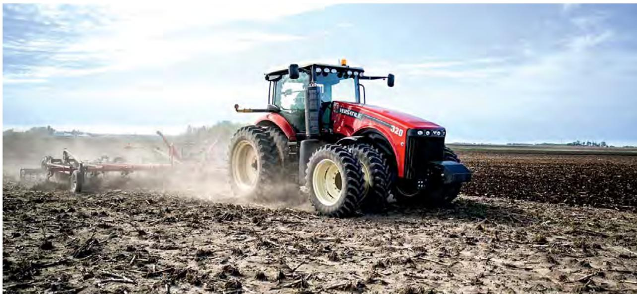
**Модельная линейка сельскохозяйственных тракторов Ростсельмаш представлена машинами 6-8 тягового класса мощностью 305-620 л.с. Тракторный «портфель» составлен с точки зрения применимости машин в условиях больших объемов работ и предпочтений сельхозпроизводителей по технологиям почвообработки с учетом подходов по агрегатированию с различными видами оборудования.**
