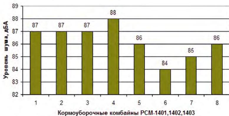
**Рис. 3. Уровни шума в кабинах кормоуборочных комбайнов при уборке кукурузы на силос:**
