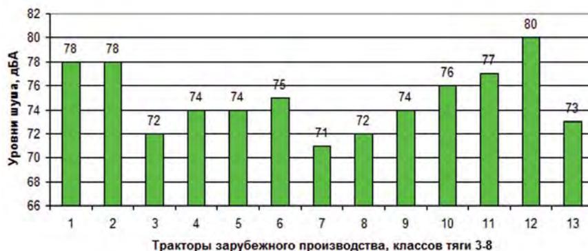
**Рис. 2. Уровни шума в кабинах колесных тракторов зарубежного производства при выполнении пахотных работ:**
