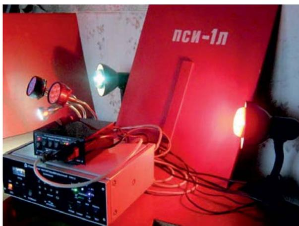
Рис. 7. Применение АМИС-8 совместно с контроллером КИС-1 для магнитно-импульсного воздействия на растения с дополнительным синхронным светоимпульсным облучением светодиодными лампами накаливания
