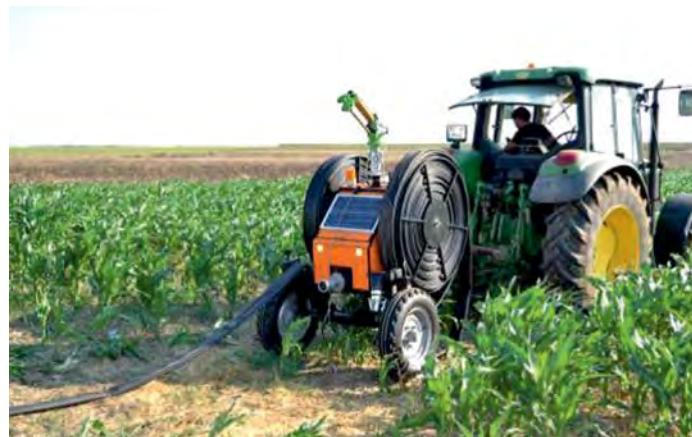
**Рис. 3. Тросо-барабанная дождевальная установка «Радуга»**
