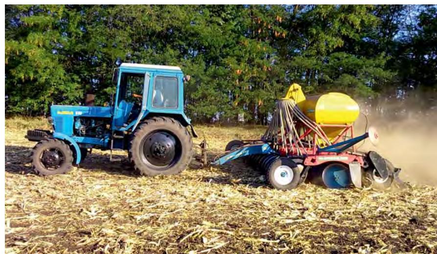
Общий вид почвообрабатывающе-посевного комплекса Р-4,2 в агрегате с трактором МТЗ-82 на посеве озимой пшеницы
