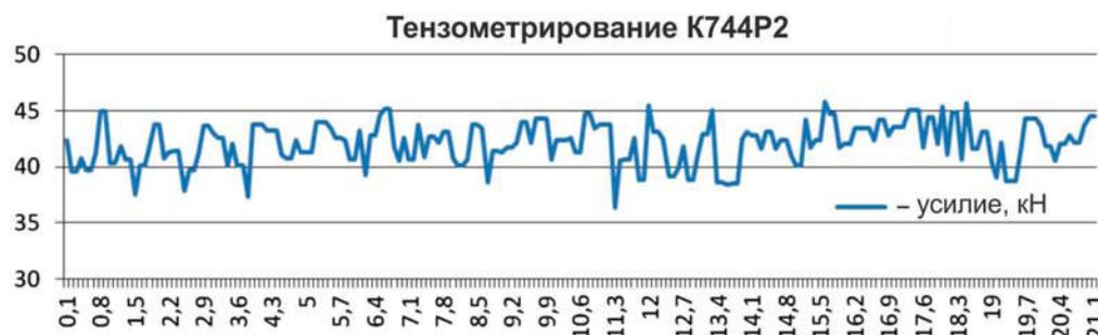
**Рис. 1.** График изменения тягового усилия трактора K744P2
