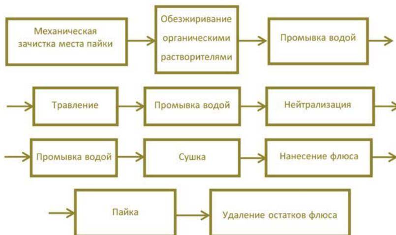
**Рис. 2. Последовательность операций пайки [1]**
