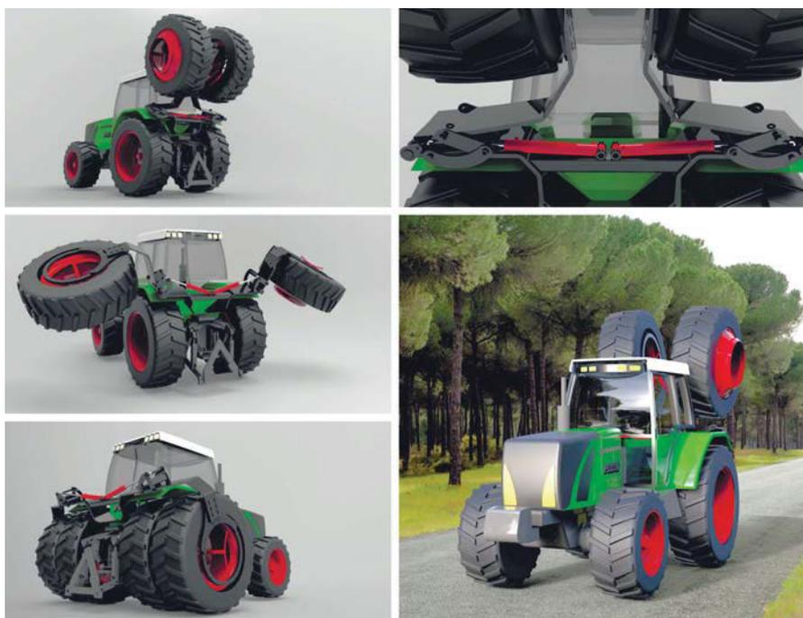
**Рис. 3. Система складывания дополнительных колес**
