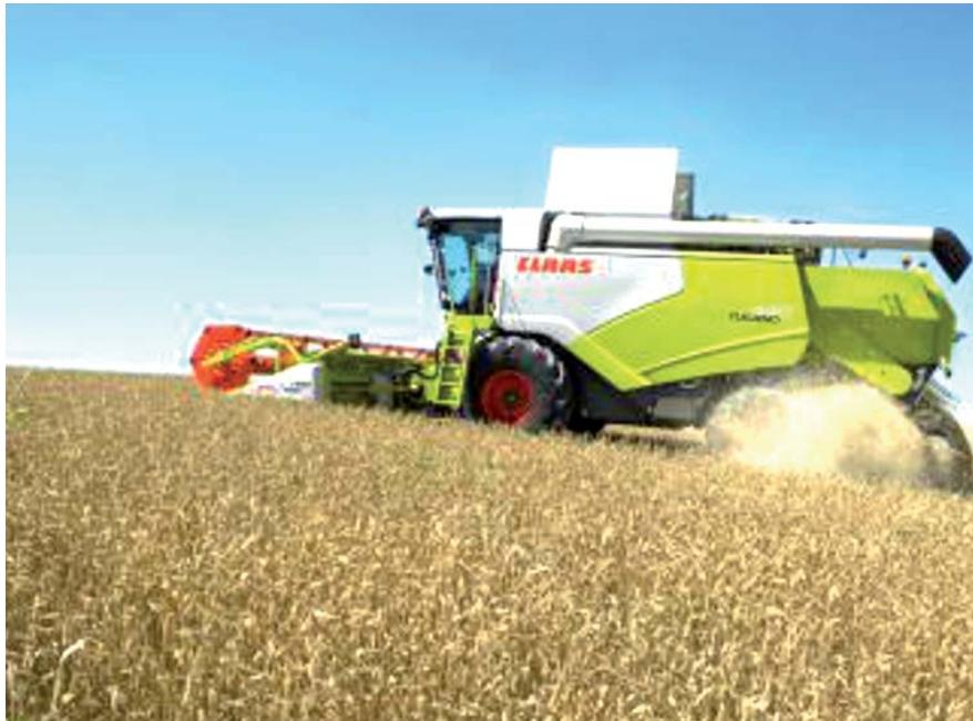
из пяти возможных позиций от -10 до 10 см. Положение стола фиксируется десятью болтами. Диаметр шнека жатки на четырех новых моделях был увеличен на 14%, что позволяет увеличить поток массы. Привод шнека и режущего аппарата осуществляется механически с помощью карданных валов.
