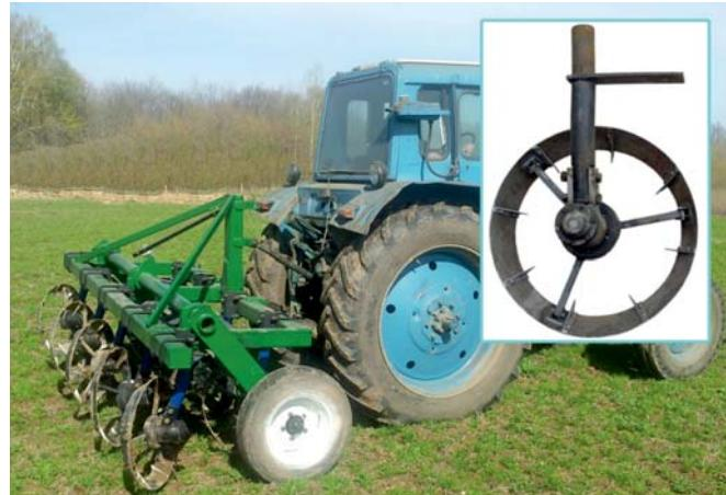
Рис. 1. Почвообрабатывающее орудие с ротационными коническими рабочими органами
