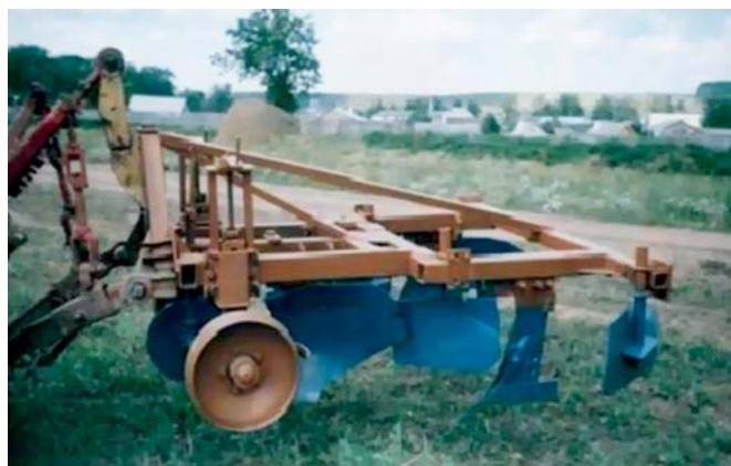
**Рис. 2. Опытный образец плуга ПФЛН-1,6**
