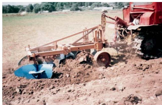
**Рис. 3. Опытный образец плуга ПФЛН-1,6 в работе**
