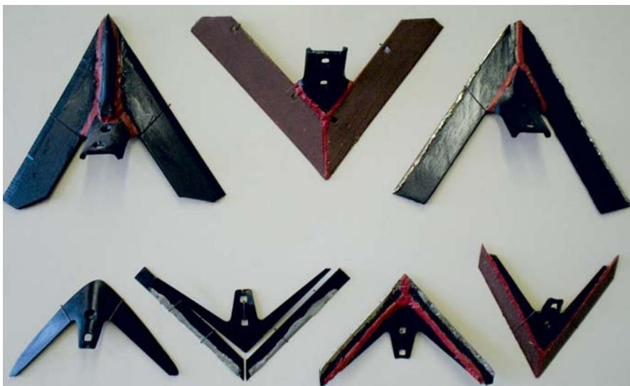
Культиваторные лапы, восстановленные и упрочненные наплавкой твердосплавным материалом Сормайт-1
