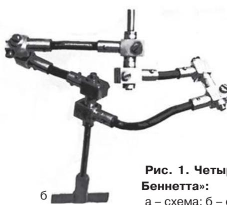
Рис. 1. Четырехзвенный «механизм Беннетта»:
