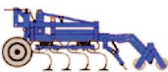
**– КБМ-9,6 ПС-4Д.** Культиватор блочно-модульный прицепной (облегченный, узкая пружинная стойка со стрельчатой лапой в четыре ряда, ширина лапы 105 мм, планочно-зубовой выравниватель, двойной роторный каток).
