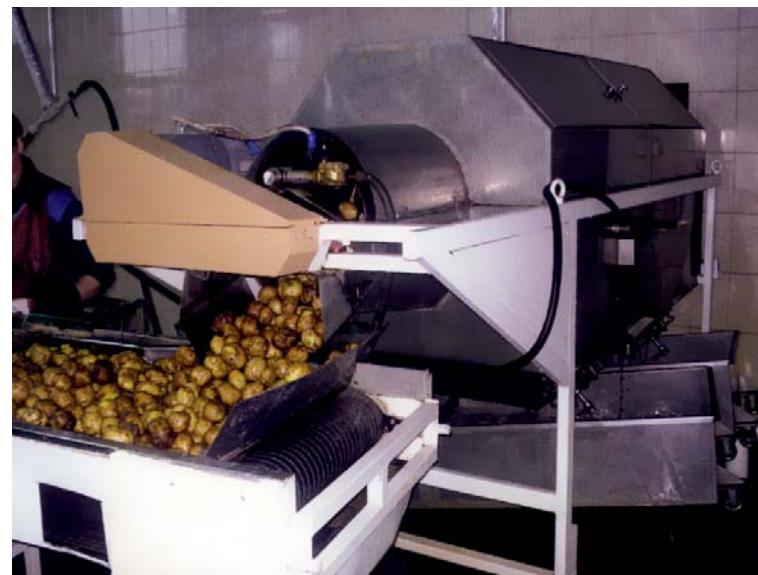
**Рис. 5. Оборудование для предварительной подготовки овощей, фруктов к сушке**
