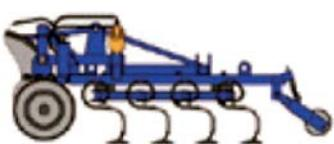
**– КБМ-14,4 ПС «Универсальный».** Культиватор блочно-модульный прицепной (усиленная пружинная стойка со стрельчатой лапой, 120 рабочих органов в три ряда, планочно-зубовой выравниватель и роторный каток).
