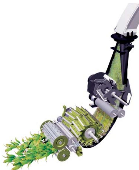
**Рис. 3. Технологическая схема кормоуборочного комбайна JAGUAR**
