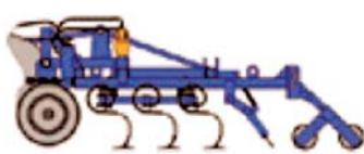
**– КБМ-14,4 ПС-4 «Урожайный».** Культиватор блочно-модульный прицепной (стрельчатая лапа, 120 рабочих органов в четыре ряда и роторный каток).
