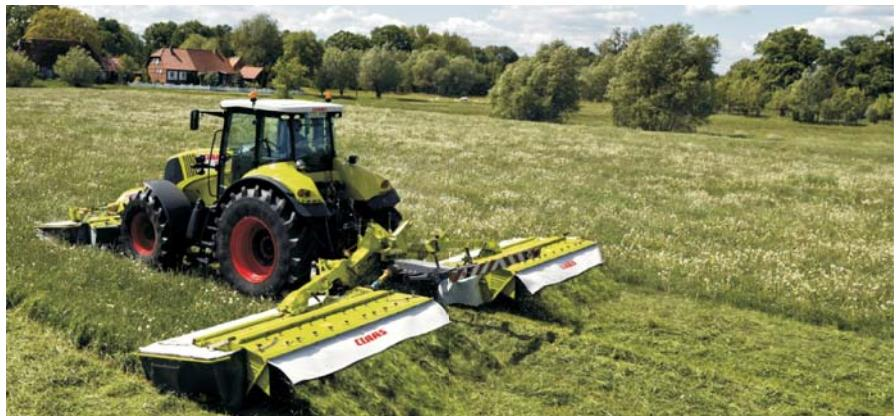
**Рис. 1. Агрегат из двух косилок DISCO, фронтальной 3050 С и задненавесной 8550 С**
