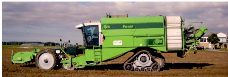
**Рис. 1. Самоходный картофелеуборочный комбайн AVR Puma+ с ботводробителем Rafale**
