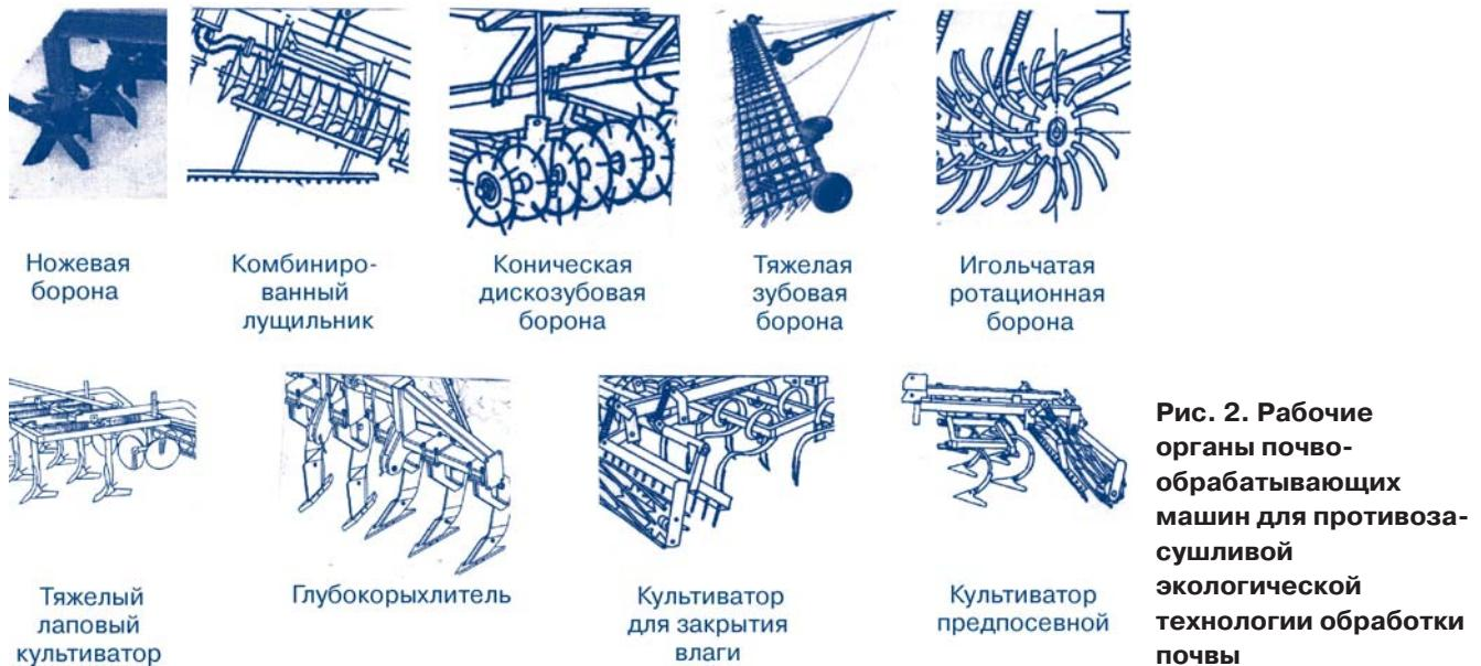
**Рис. 2. Рабочие органы почво-обрабатывающих машин для противозасушливой экологической технологии обработки почвы**
