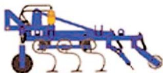
**– КБМ-8 ПС-К.** Культиватор блочно-модульный прицепной (передний опорный каток, пружинная стойка, три ряда рабочих органов, планочно-зубовой выравниватель и роторный каток).
