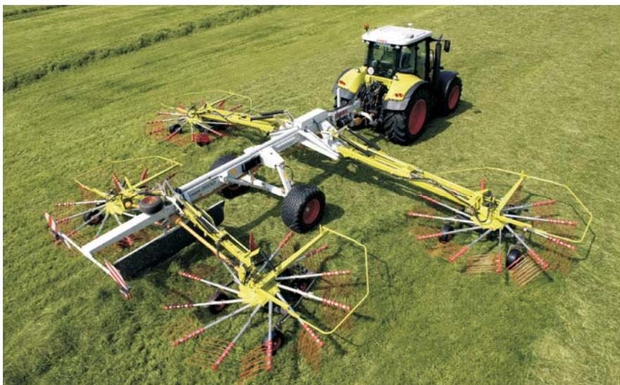
Рис. 2. Четырехроторный валкообразователь LINER 3500
