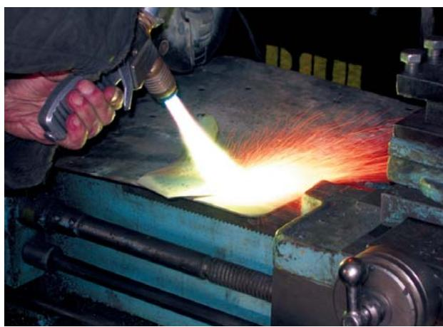
Рис. 1. Напыление лапы культиватора КППШ-6 порошком экспериментального состава
