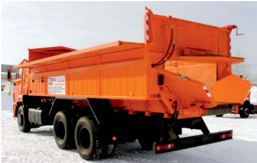
**Рис. 2. Автомобиль БАЛТ «Гранд-Полевик» (картофелевоз)**
