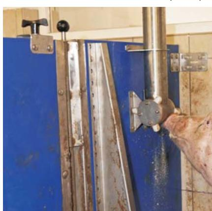
**Рис. 5. Электронный дозатор сухого корма**
