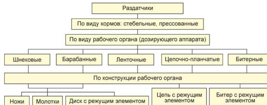
Рис. 3. Классификация кормораздатчиков
