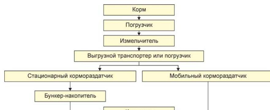
Рис. 2. Технологическая линия приготовления и раздачи кормов
