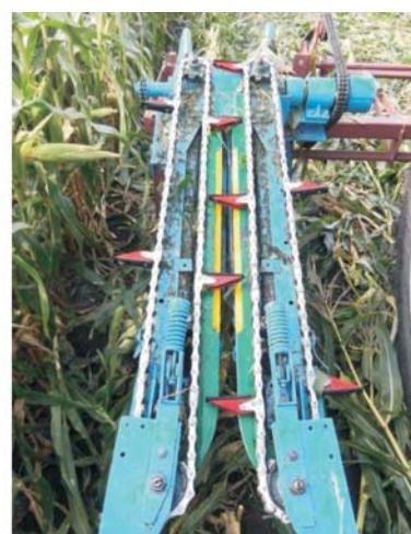
Рис. 8. Однорядный кукурузоуборочный комбайн с новыми початкоотделяющими пластинами и лапками подающих цепей
