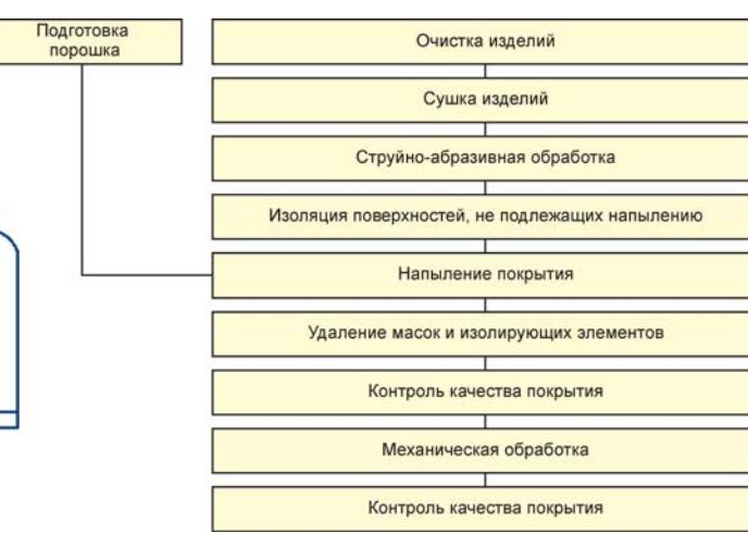
Рис. 6. Технологическая схема нанесения покрытий высокоскоростным газотермическим напылением
