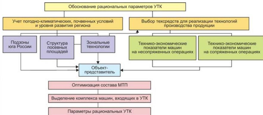
**Рис. 2. Схема последовательности обоснования организационно-технологических параметров УТК при уборке зерновых колосовых культур для южных регионов России**
