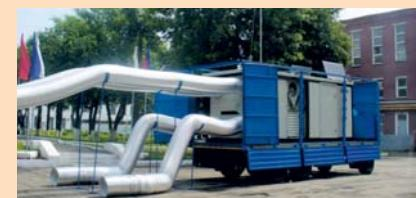
лять оборудование в любое место. Установка управляема одним оператором и быстро входит в рабочий режим. Оборудование эксплуатируется круглосуточно и безаварийно в сложных климатических условиях – от -50 до +50° С.
