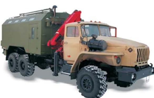
Рис. 2. Мастерская ММПУ на шасси Урал-4320 с краном-манипулятором БАКМ-890
