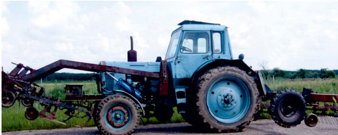
Рис. 2. Гидронавесное устройство для фронтального агрегатирования
