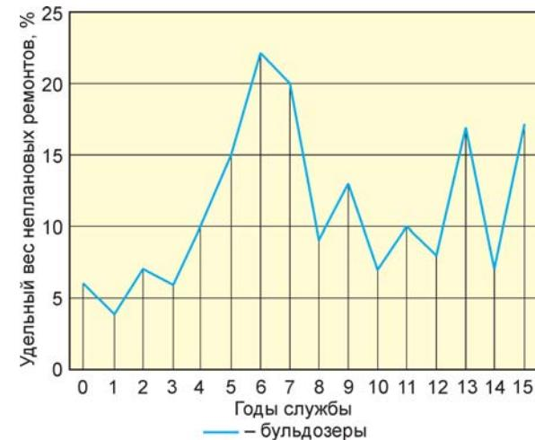
Рис. 1. Зависимость удельного веса неплановых ремонтов от возраста машин
