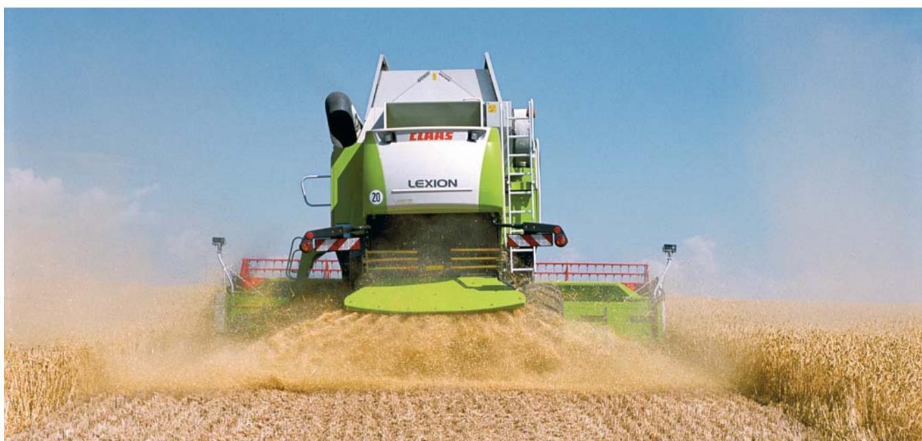
**Равномерное распределение соломы по всей рабочей ширине захвата**
