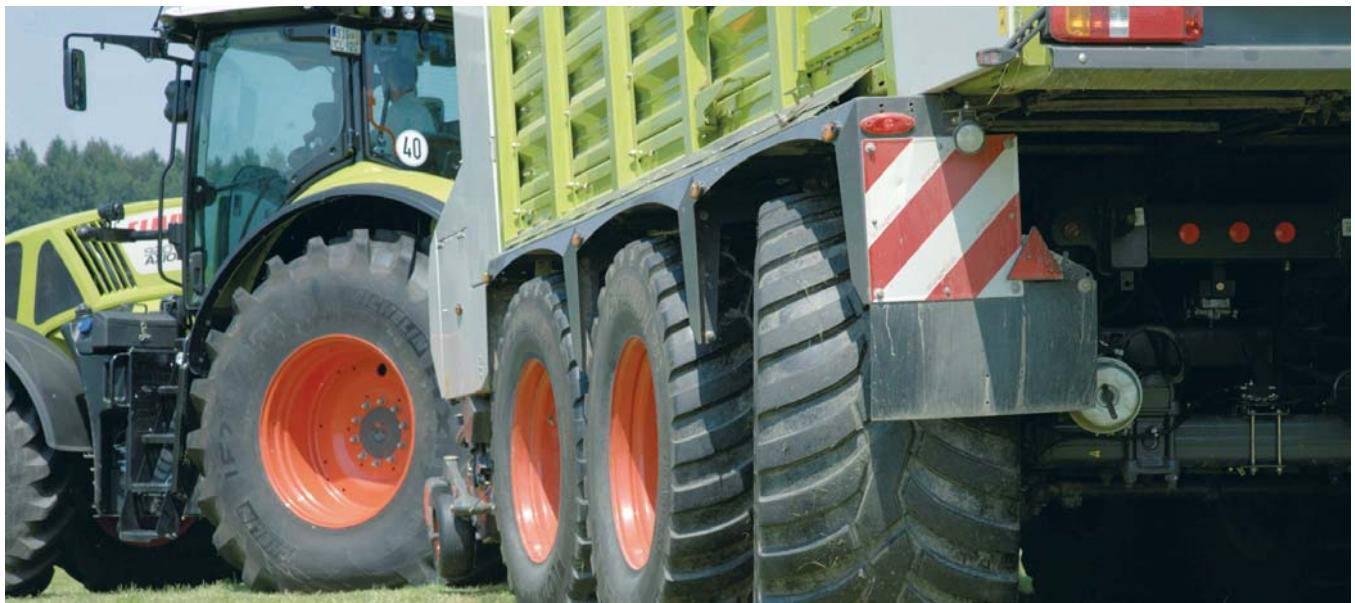
**Система оптимизации электронно-гидравлического принудительного управления для осей прицепов**
