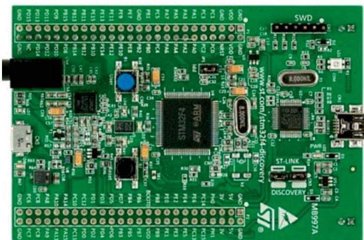
Рис. 1. Микропроцессорная плата STM32F4DISCOVERY
