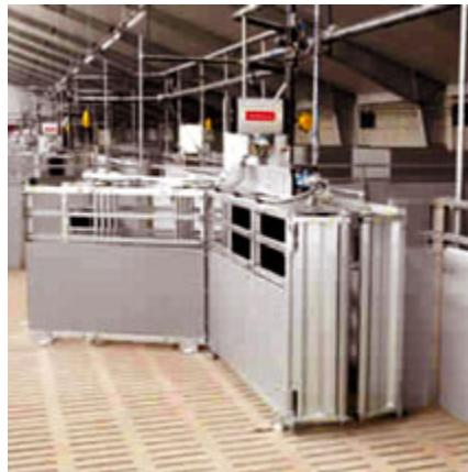
**Рис. 5. Автоматизированная кормовая станция SowCompFeeder фирмы «WEDA Dammann & Westerkamp GmbH»**
