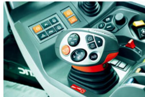
**Рис. 4. Многофункциональный джойстик CMOTION**
