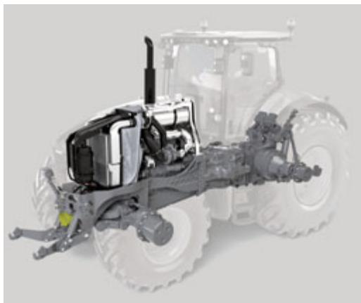
**Рис. 2. Рама трактора AXION 900**
