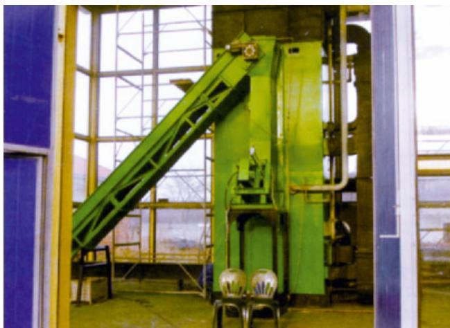
**Рисунок 1 – Топочное устройство с системой многозонного воздушного дутья**
