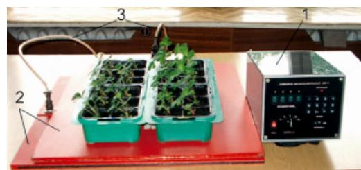
**Рисунок 1 – Стимулятор магнитно-импульсный СМИ-4:**
