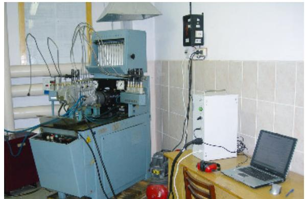
**Установка для регулировки топливной аппаратуры с ЭСУ**
