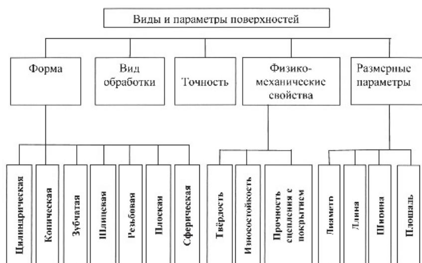
**Рисунок 2 – Характеристика поверхностей деталей**
