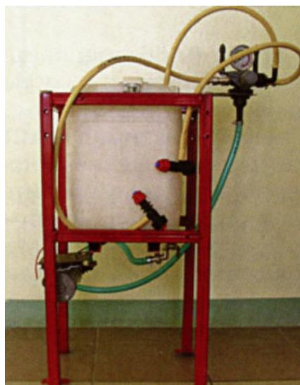
**Рисунок 2 – Приспособление к картофелесажалке для проправления клубней картофеля непосредственно при посадке**
